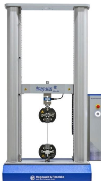
Slika 30. Uređaj za mjerenje smične čvrstoće Inspekt Blue 20 [22]
