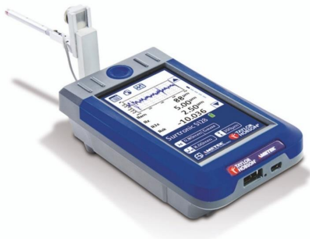
Slika 23. Uređaj za mjerenje hrapavosti Surtronic S-116 [21]
