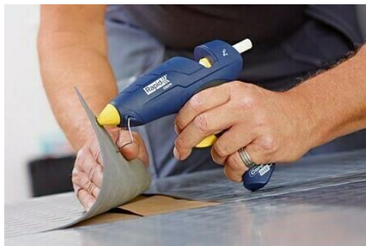
Slika 13. Pištolj za nanošenje ljepila [13]
