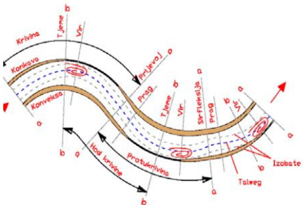
Slika 2.1. Osnovni pojmovi morfoloških elemenata vodotoka [3], [5]
