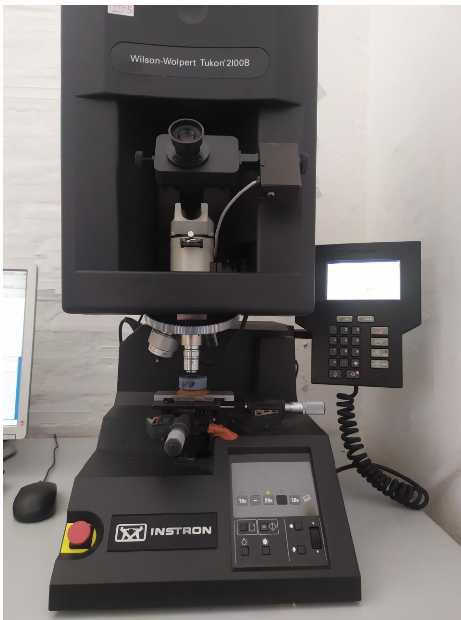
Slika 38. Tvrdomjer s postavljenim uzorkom
