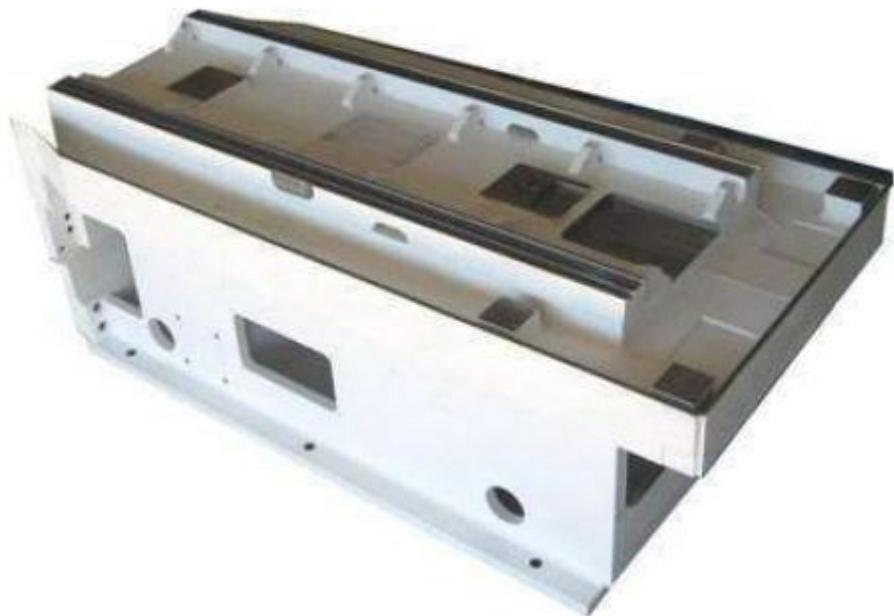
*Slika 5 Zavarena izvedba postolja stroja [1]*
