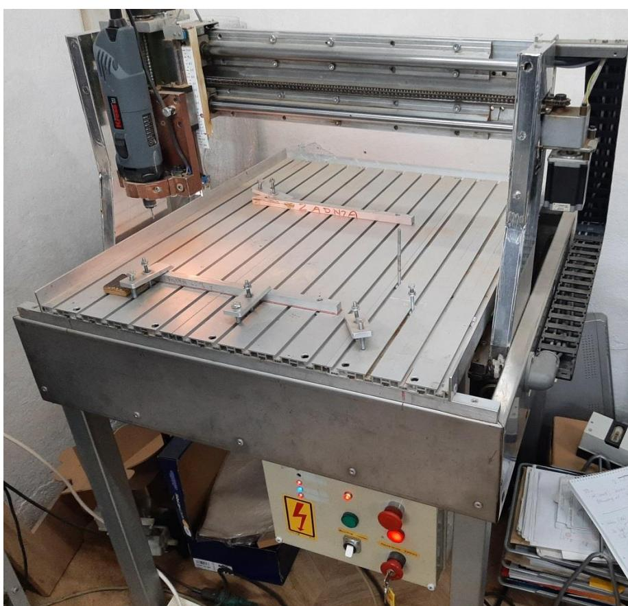
*Slika 18 Izrađena konstrukcija CNC stroja za graviranje*
