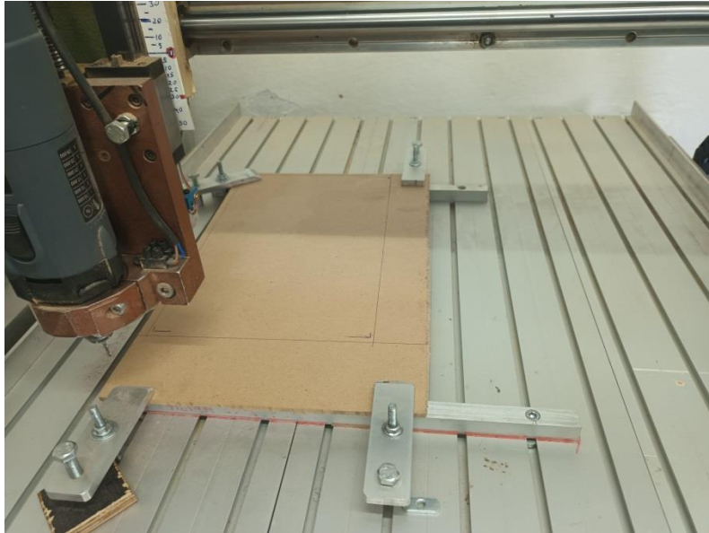
Slika 20 Stezanje obratka na radnom stolu
