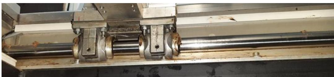
Slika 23 Cilindrična osovina i ležajevi za x-os
