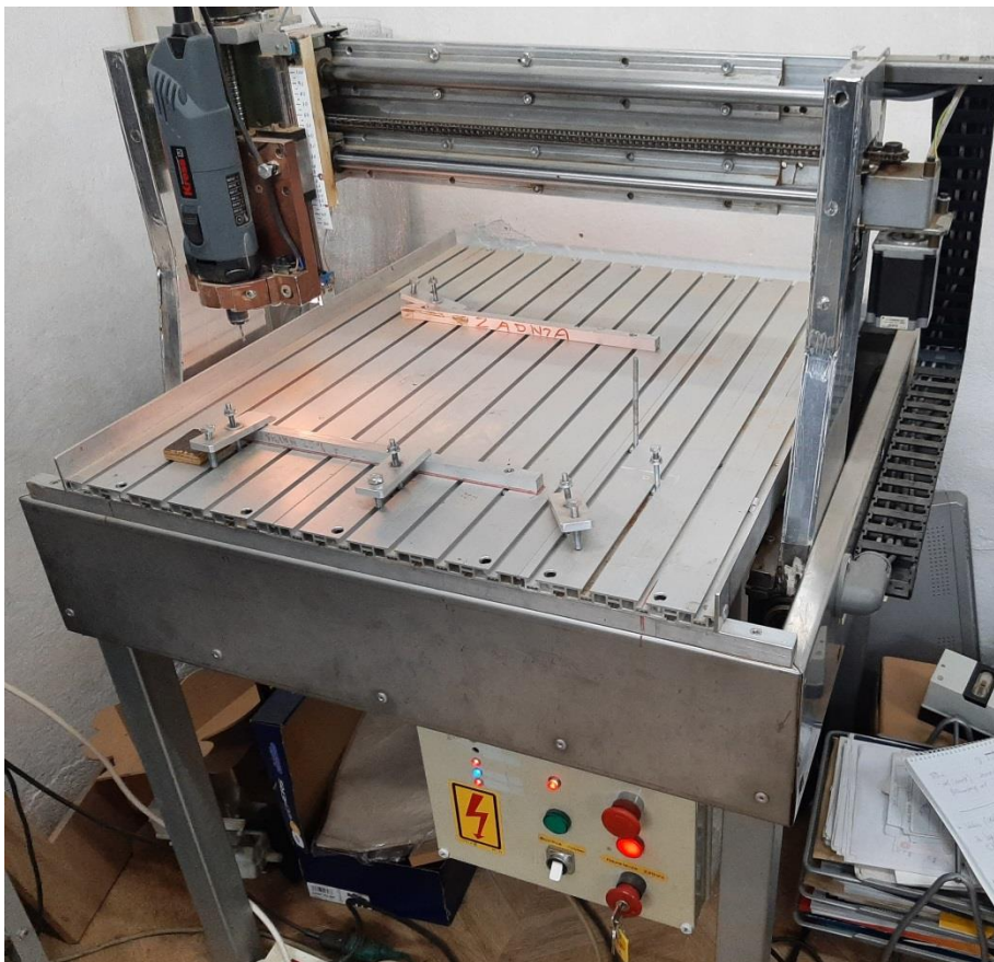
Slika 18 Izrađena konstrukcija CNC stroja za graviranje
