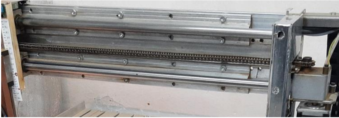
Slika 24 Vođenje po y-osi
