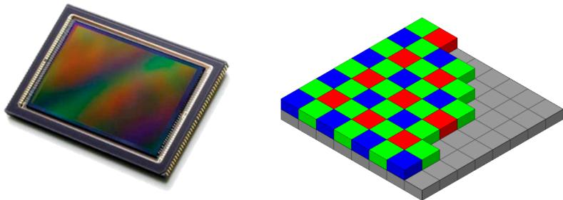
*Slika 2.2. Fotoosjetljivi senzor (slika lijevo)*
