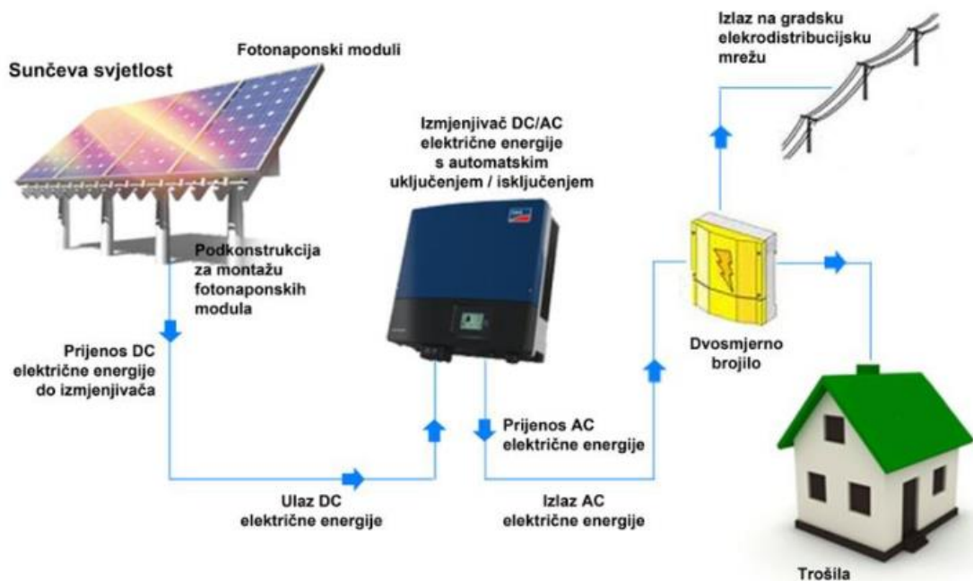
Slika 12. Shema On-grid sustava [7]
