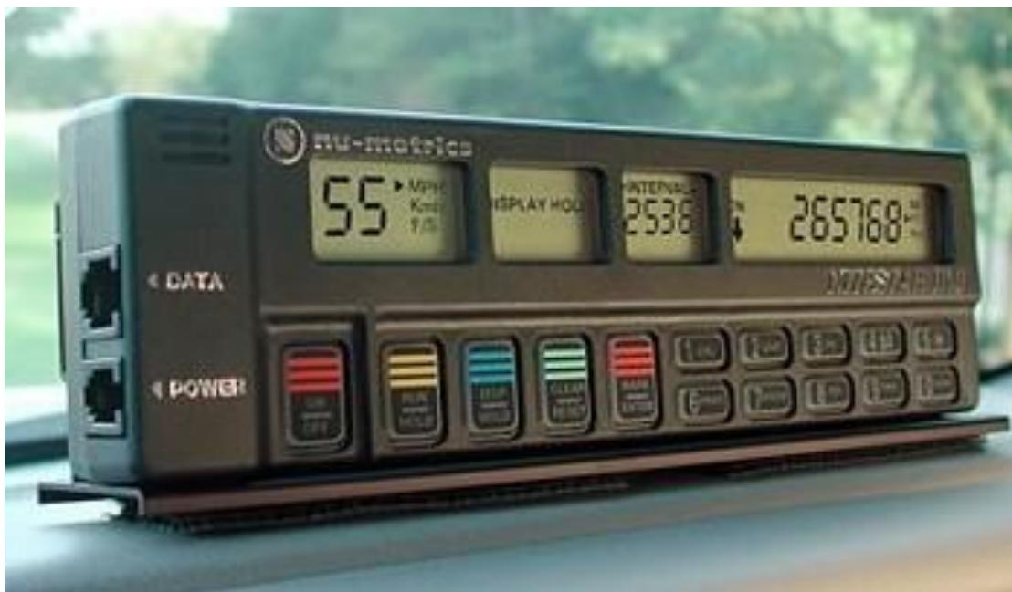
Slika 11. Digitalni mjerač udaljenosti NITESTAR NS-60 [27]
