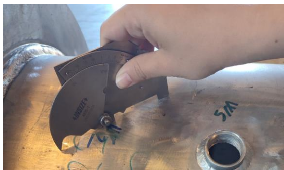
Slika 3.4 Mjerenje nadvišenja zavra
