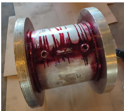
Slika 3.8 Penetrirana prva konstrukcija
