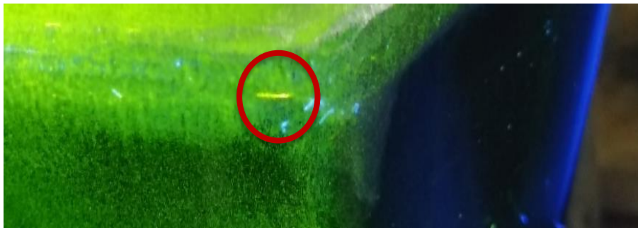
Slika 2.13 Indikacija u zavarenom spoju
