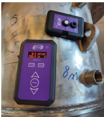
Slika 3.3 Mjerenje jačine svjetlosti
