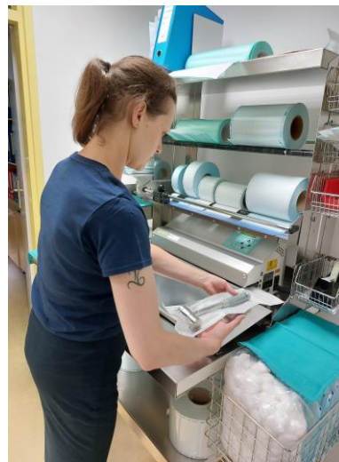
Slika 3.2.7. Pakiranje instrumenata u instrument foliju za sterilizaciju u autoklavu (Izvor: L. B.)
