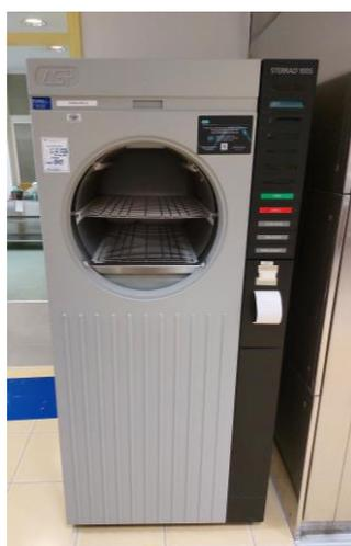
Slika 3.2.4. Plazma sterilizator
