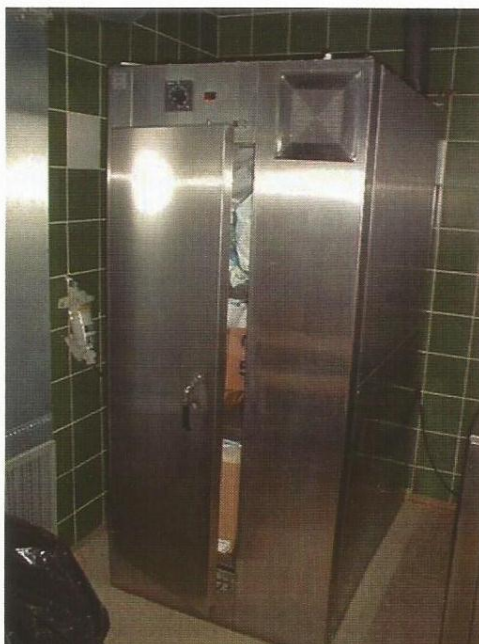
Slika 2.6.5.1. Ormar za prozračivanje etilen-oksida
