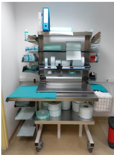
Slika 3.2.3. Stroj za pakiranje instrument folija za autoklav (Izvor: L. B.)
