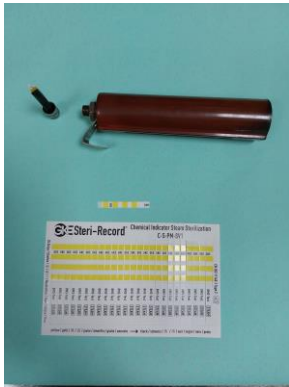
Slika 3.2.11. Kemijska indikator traka (Izvor: L. B.)
