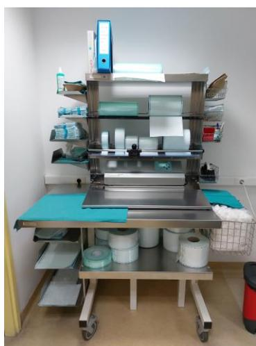
Slika 3.2.3. Stroj za pakiranje instrument folija za autoklav
