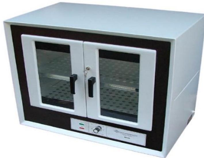
Slika 2.6.3.1.1. Sterilizator suhim zrakom
