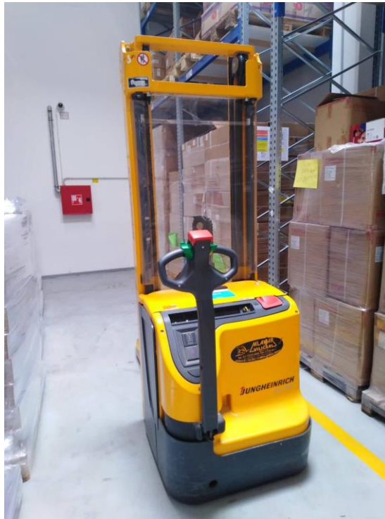
Slika 11. Visokopodizni skladišni viličar [11]
