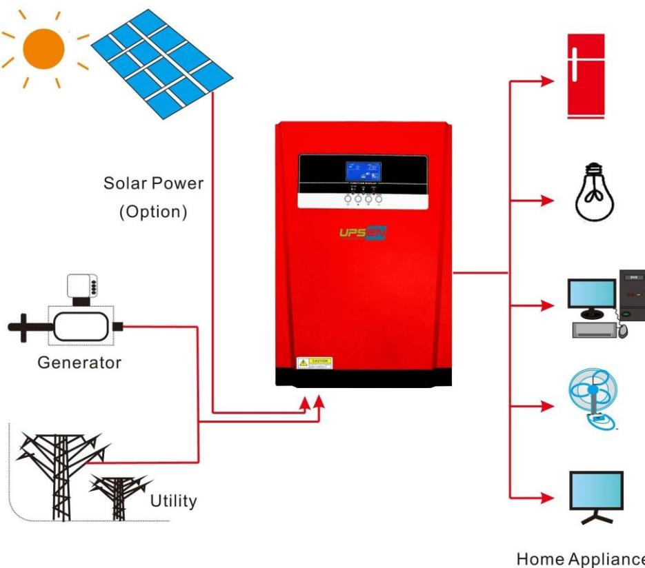
*Slika 2.13 Samostalni tip pretvarača, sa primjerom spojenih ulaza i izlaza
