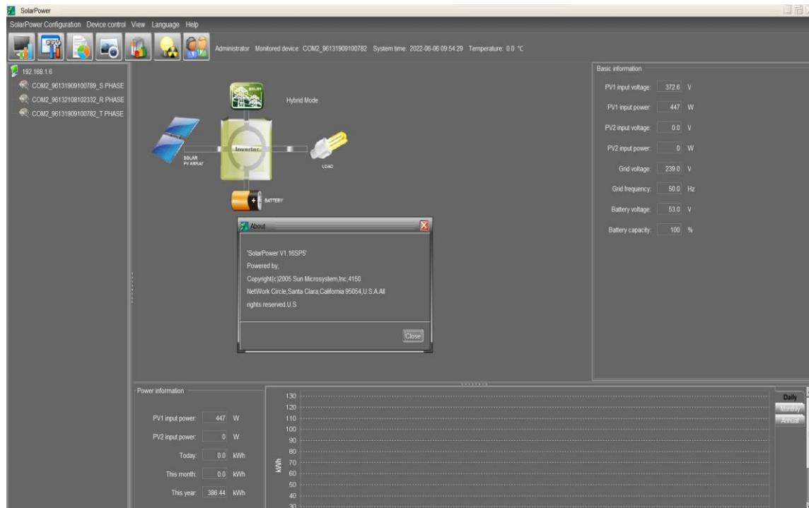
Slika 2.23 SolarPower software za programiranje i praćenje pretvarača
