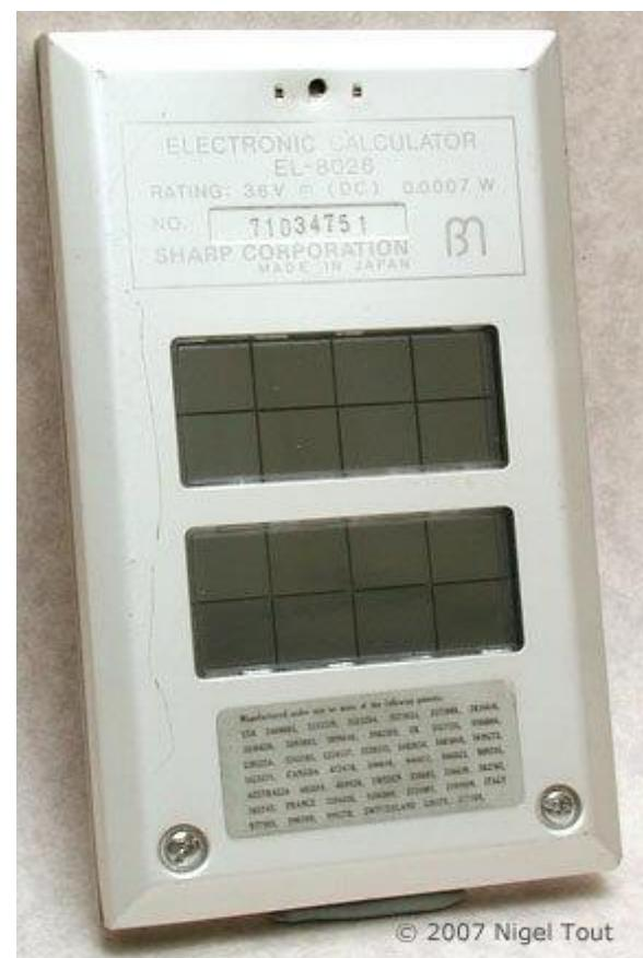
Slika 2.3 Prvi solarni kalkulator Sharp EL-8026 odzada gdje su solarne čelije
