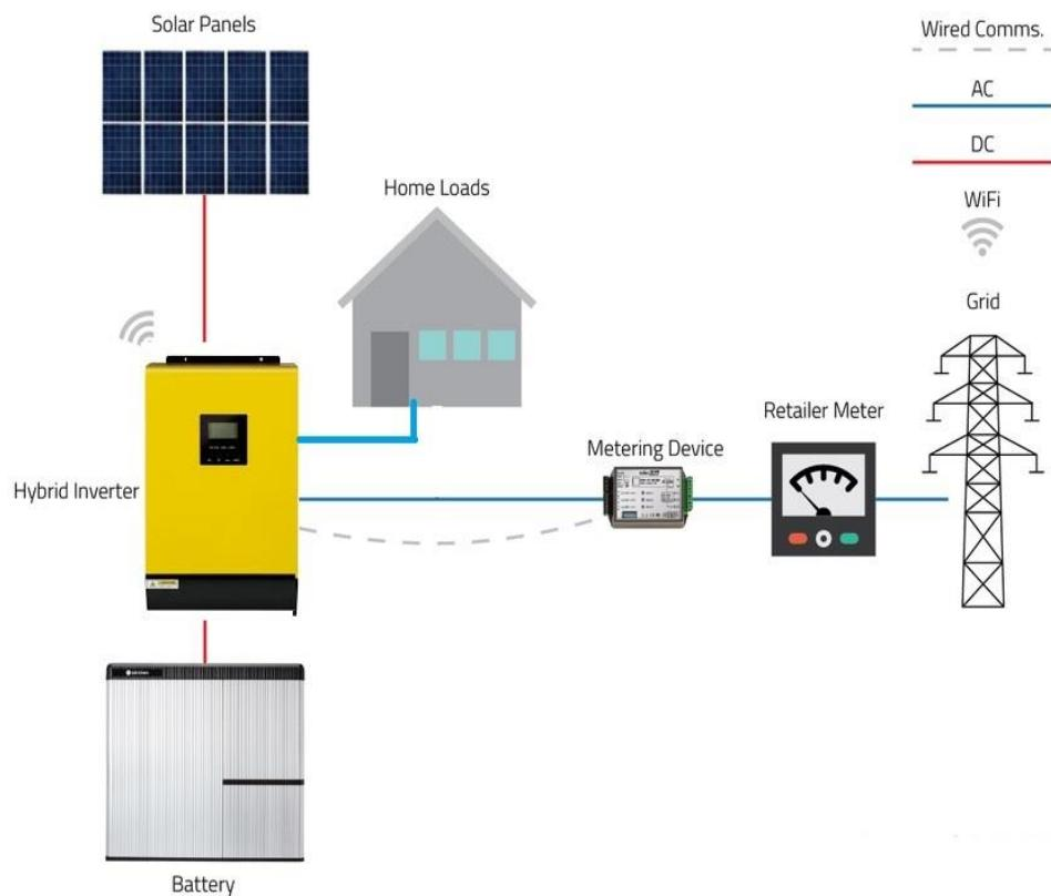
*Slika 2.14 Hibridni pretvarač s primjerom spajanja na mrežu i kuću*
