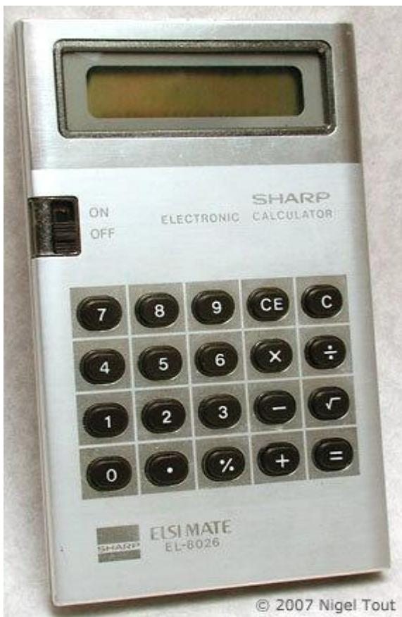
Slika 2.4 Prvi solarni kalkulator Sharp EL-8026 sprijeda
