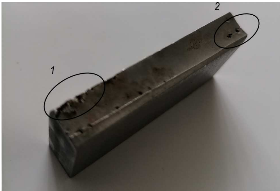
Slika 41. Fotografija površine uzorka 1 (čelik AISI 2101) nakon izlaganja korozivnom okolišu
