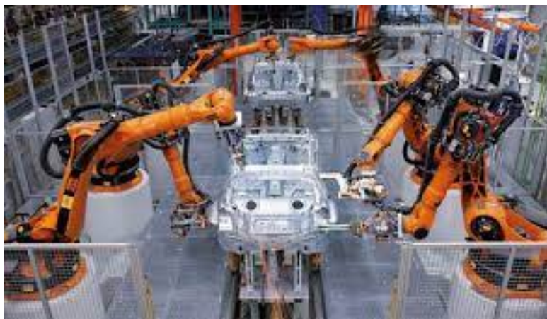
Slika 17. Prikaz elektrootpornog točkastog zavarivanja u automobilskoj industriji
