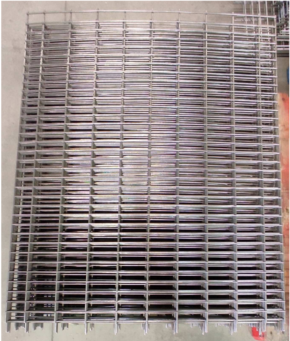
Slika 40. Prikaz gotove žičane mreže nakon rezanja viškova
