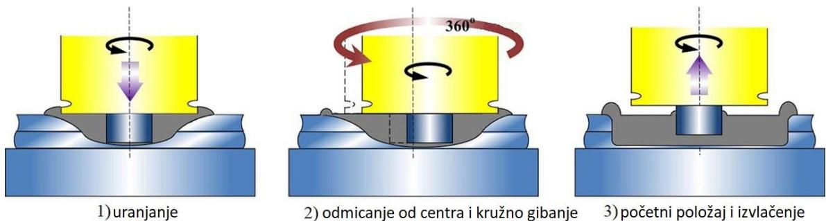
Slika 4.12 Shema Swept FSSW postupka zavarivanja [19]
