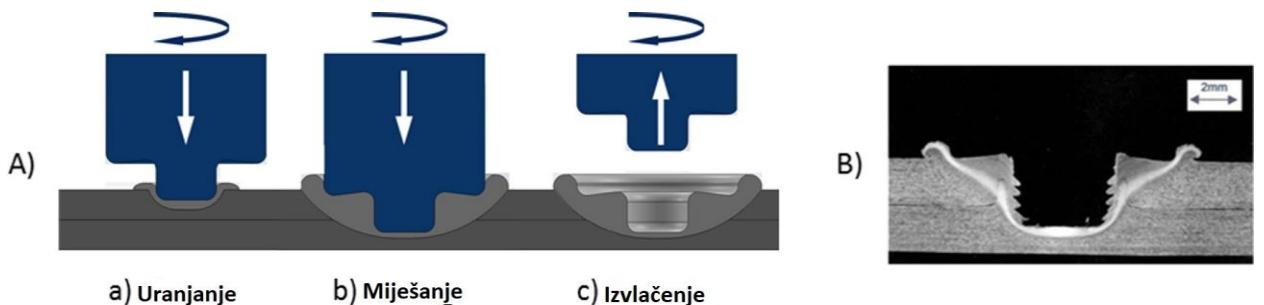
Slika 4.6 A) Shematski prikaz konvencionalnog FSSW postupka zavarivanja; B) Poprečni presjek zavara dobiven FSSW postupkom [15]
