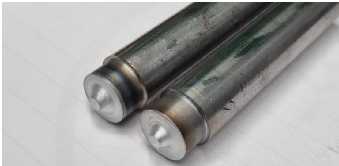
Slika 5.17 Izgled alata nakon zavarivanja
