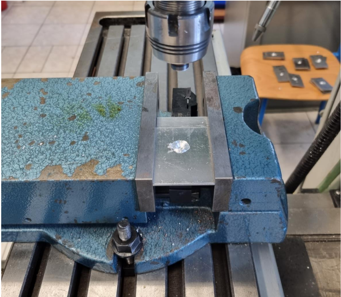
Slika 5.12 Izvlačenje alata iz uzorka
