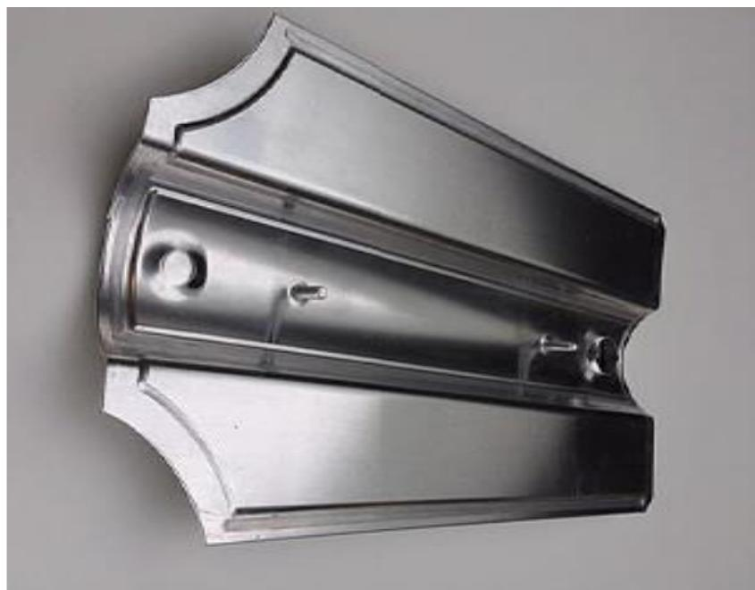
*Slika 4.26 Solarni kolektor zavaren FSW postupkom [20]*
