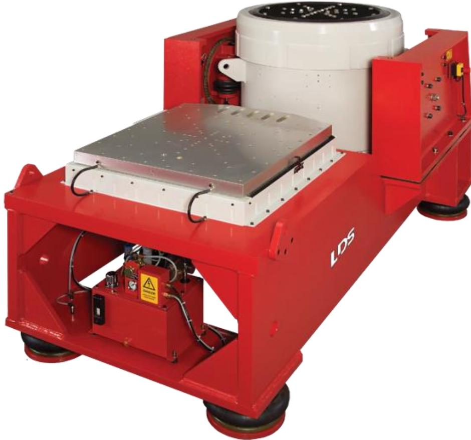
Slika 4.24 Vibracijski stol tvrtke LDS s magnezijevom pločom zavarenom FSW postupkom [28]
