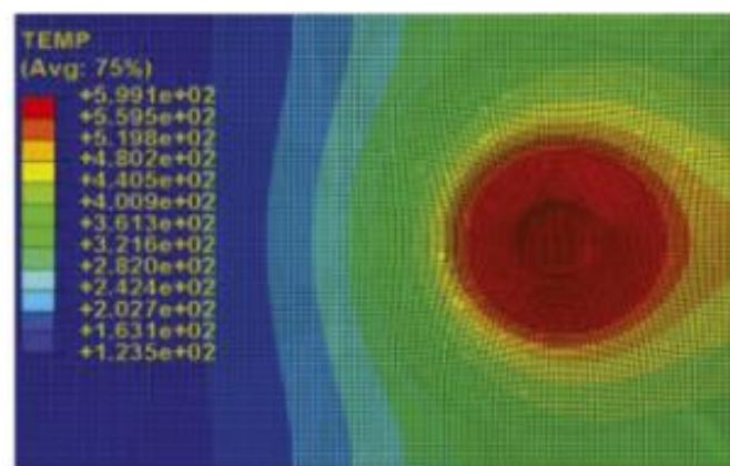
Slika 4.19 Prikaz zona zagrijavanja kod točkastog zavarivanja trenjem rotirajućim alatom [23]
