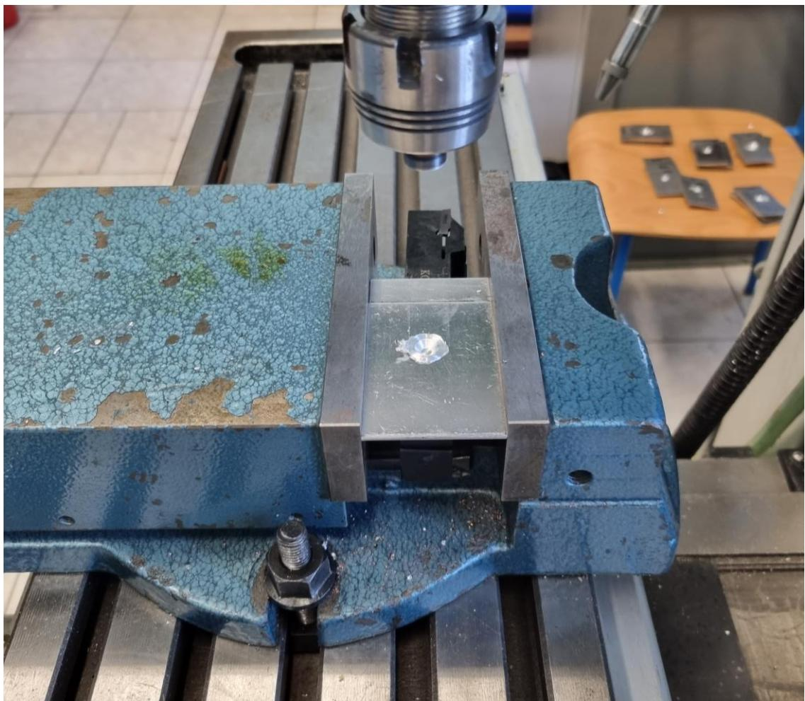
*Slika 5.12 Izvlačenje alata iz uzorka*
