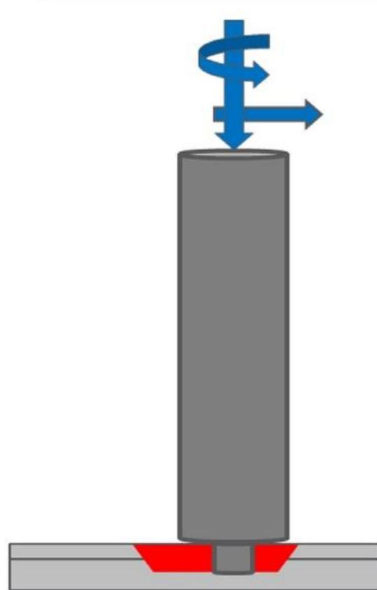
Slika 4.7 Shematski prikaz šavnog FSSW zavarivanja [17]
