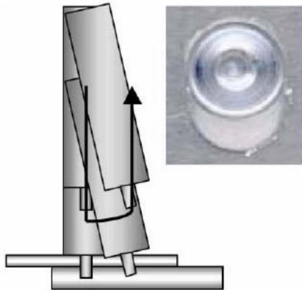
*Slika 4.8 Shematski prikaz FSSW zavarivanja s nagibom alata [18]*
