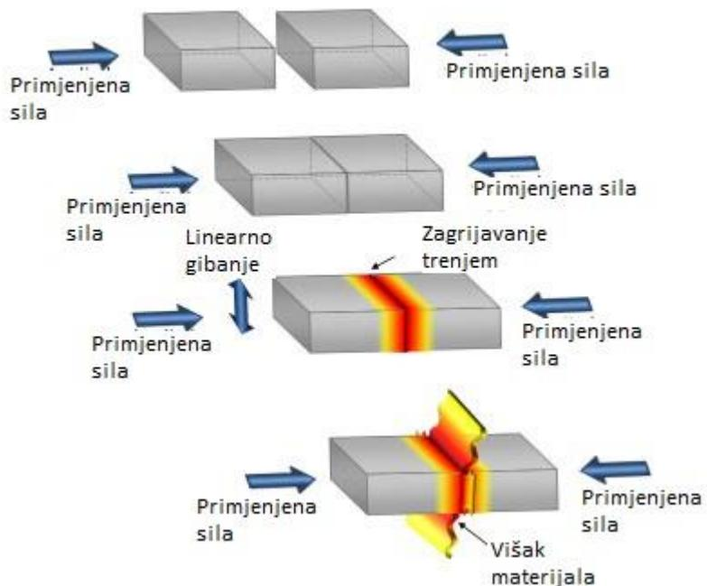
Slika 4.1 Shematski prikaz procesa linearног zavarivanja trenjem [8]
