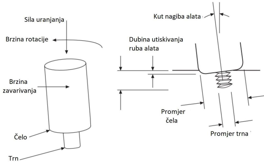
Slika 4.15 Konvencionalni FSW alat i osnovni parametri [20]
