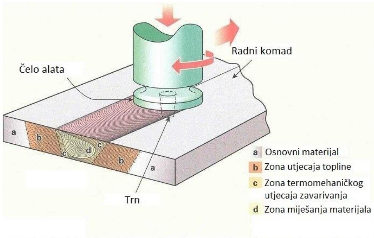
Slika 4.3 FSW proces zavarivanja [12]
