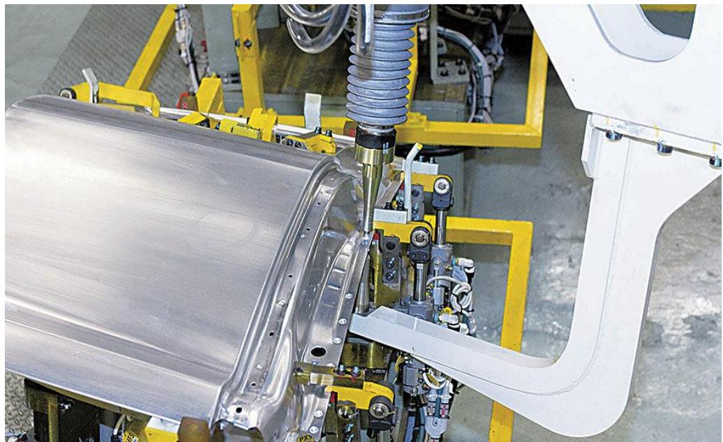
Slika 4.27 Robotsko FSSW zavarivanje u tvornici automobila [30]
