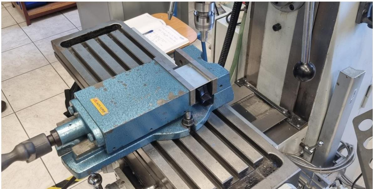
*Slika 5.9 Uzorak stegnut u škripcu na glodalici*
