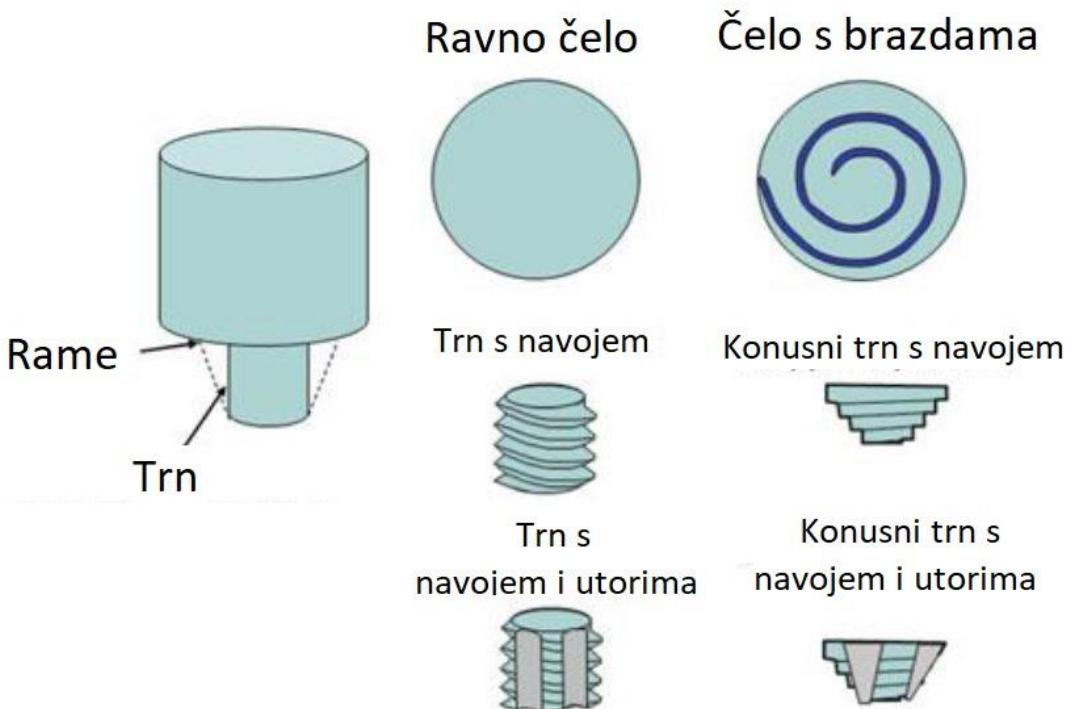
Slika 4.20 Shematski prikaz alata i oblika trna alata [20]
