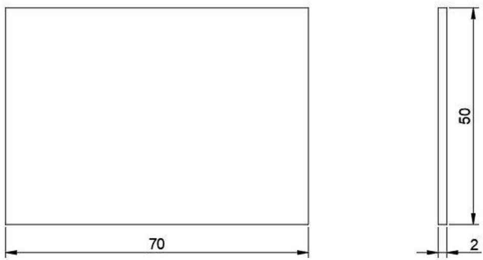
Slika 5.7 Dimenzija pločice korištene u uzorku
