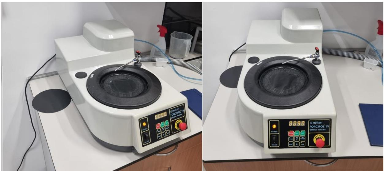
Slika 5.2 Uređaj za poliranje uzoraka
