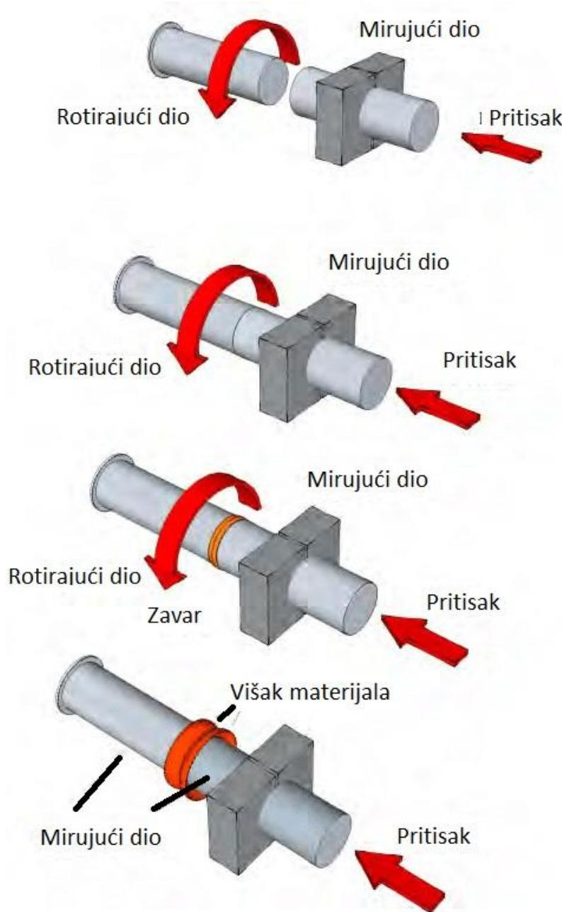
Slika 4.2 Shematski prikaz rotacijskog zavarivanja trenjem [10]
