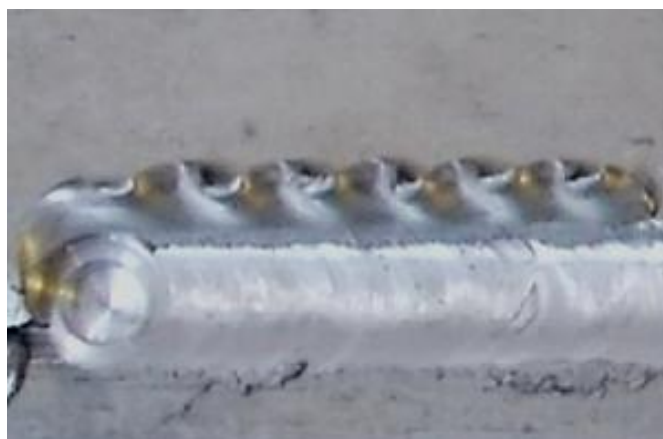
Slika 4.11. Zavar s prekomjernim istiskivanjem materijala [24]
