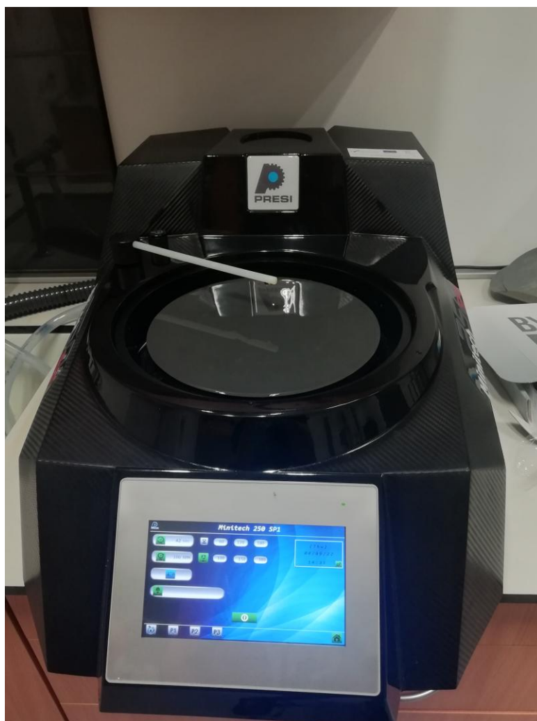
Slika 5.10. Uređaj za brušenje „MINITECH 250 SP1“
