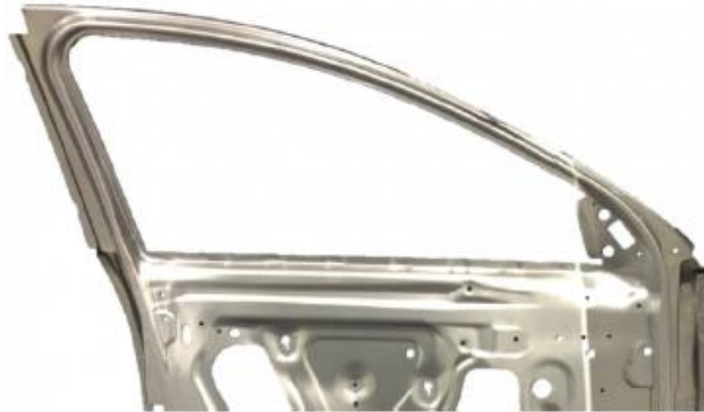
Slika 4.16. Okvir vrata automobila izrađen pomoću FSW postupka [27]
