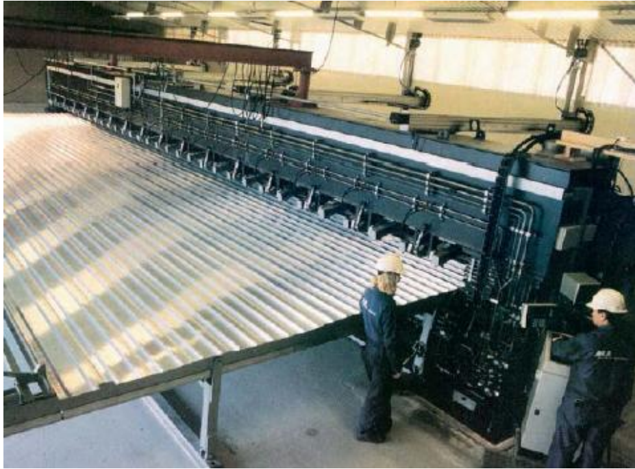
Slika 4.17 ESAB linija za FSW postupak zavarivanja ekstrudiranih aluminijskih profila u panele – Marine Aluminium Norveška [23]
