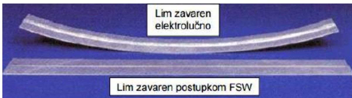
Slika 4.5. Distorzija limova zavarenih elektro-lučno i FSW postupkom [23]
