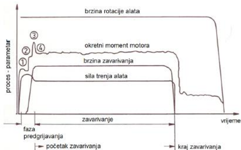
Slika 4.6. Promjena parametara zavarivanja kod FSW postupka [24]
