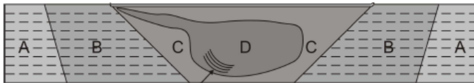
Slika 4.3. Zone zavarenog spoja kod FSW postupka [22]
