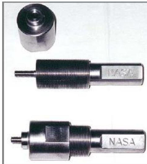
Slika 4.4. Alat za FSW postupak [5]
