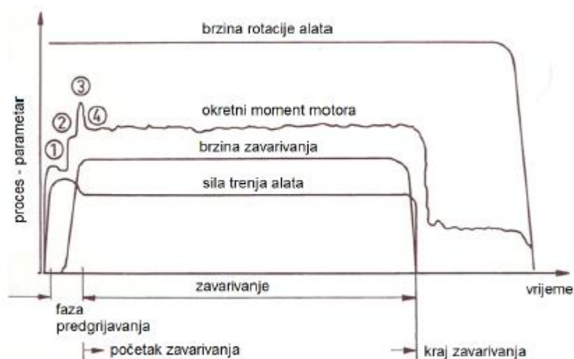
Slika 4.6. Promjena parametara zavarivanja kod FSW postupka [24]
