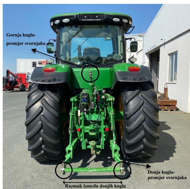
Slika 6 Prikaz glavnih dimenzija iz tablice 1 na modelu John Deere 7230R
