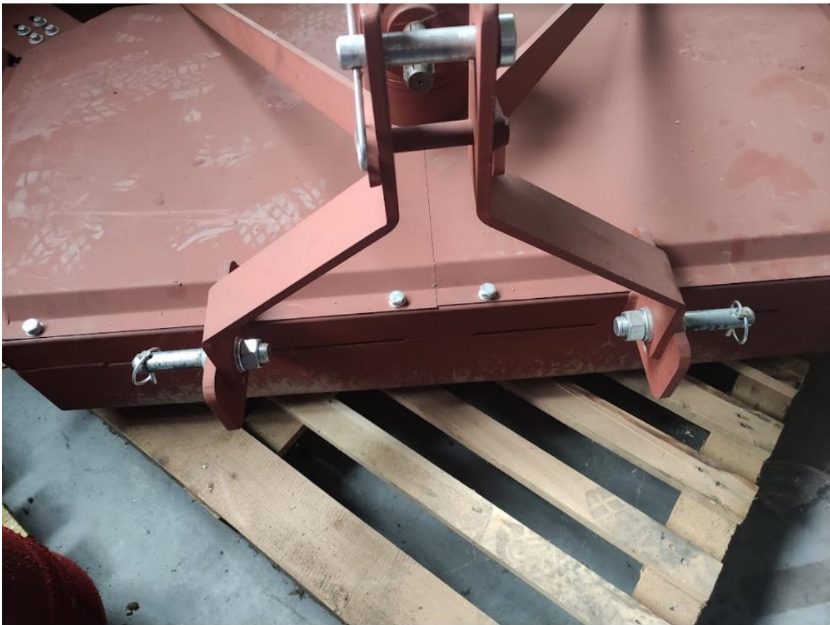
Slika 32 Priključak za traktor prototipa, 1.9.2022.
