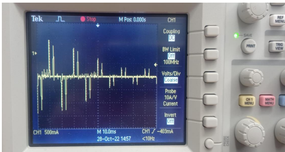
Slika 15. Prikaz struje frekvencijskog pretvarača kod brzog kočenja
