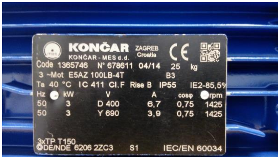
Slika 30. Pločica sa specifikacijama Končar 3 kW motora
