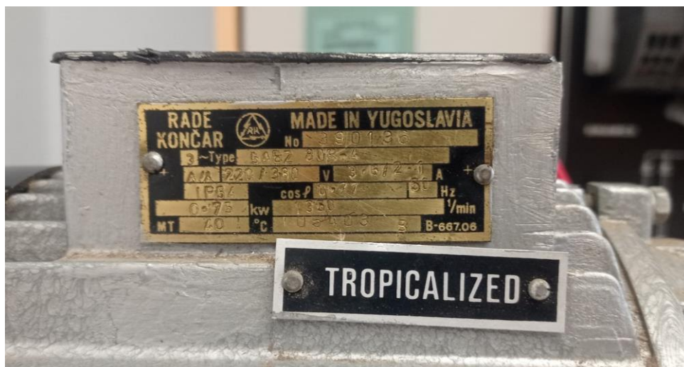
Slika 22. Pločica sa specifikacijama Končar 0.75 kW motora
