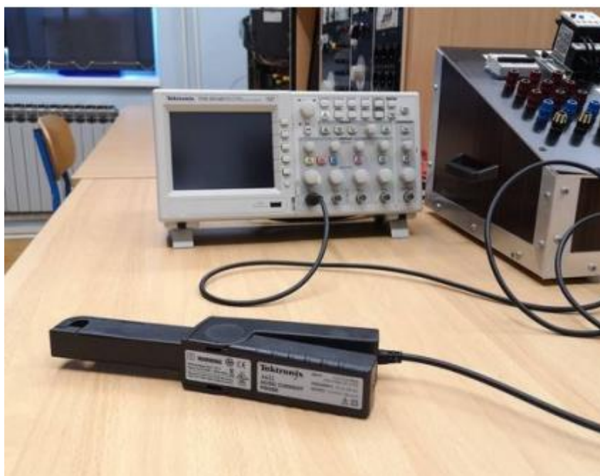
Slika 25. Osciloskop Tektronix TDS 2014B sa strujnim kliještima
