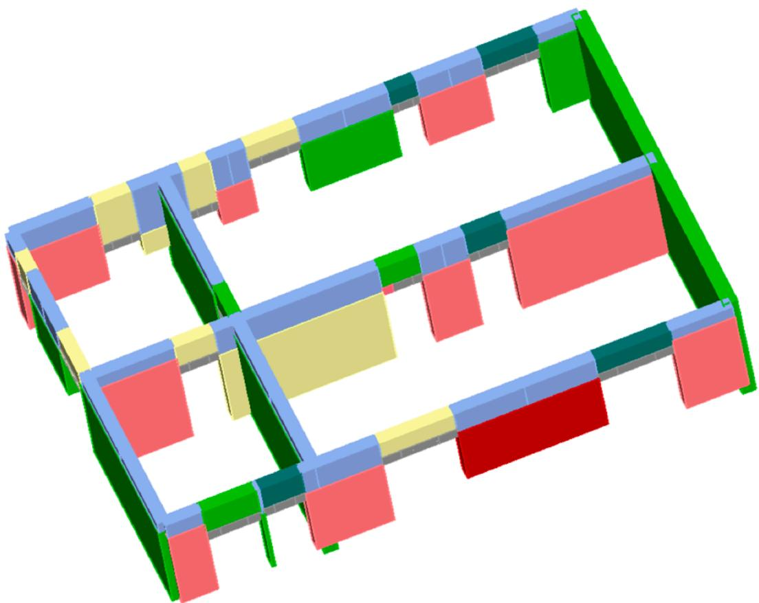
*Slika 80. Prikaz dobivenih rezultata provedenog proračuna za stanje prije potresa na aksonometriji kata*
