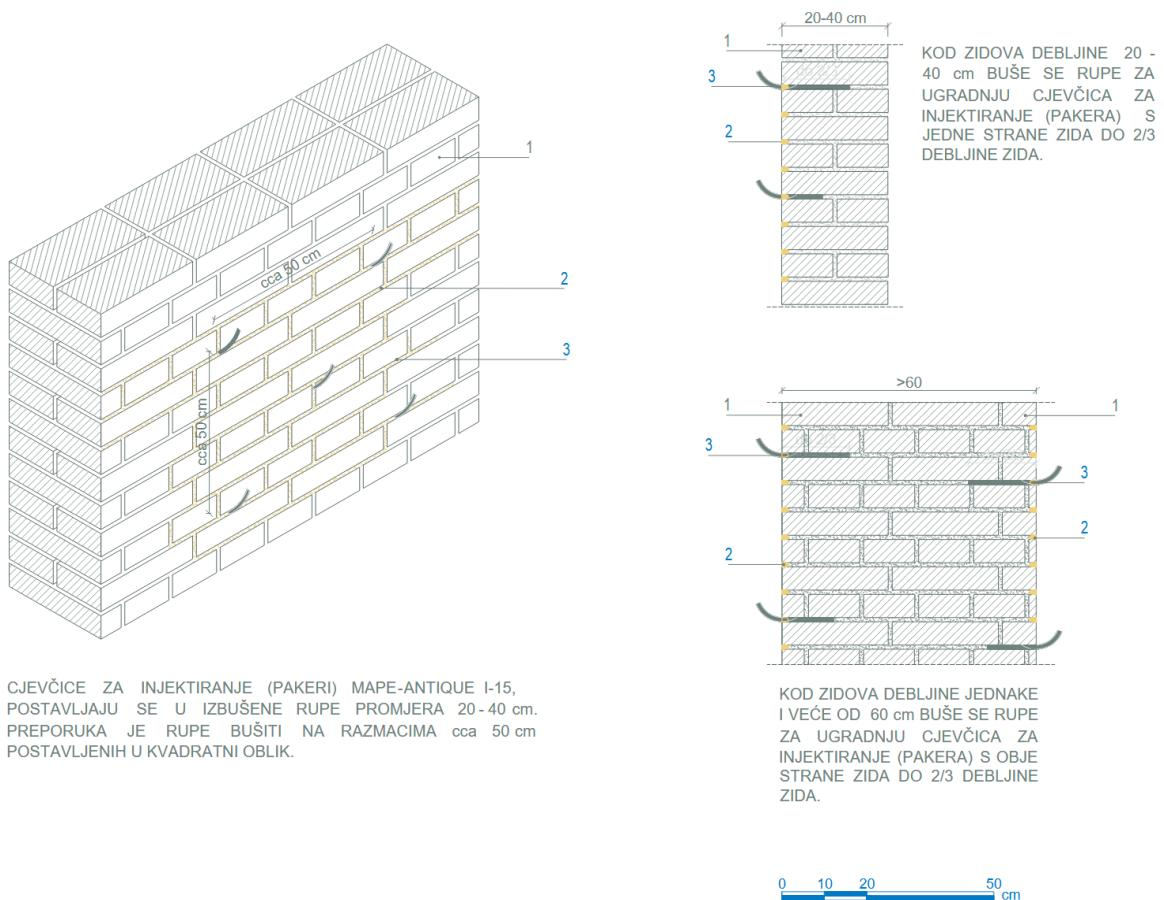
*Slika 44. Prikaz postupka injektiranja (izvor: brošura Mapei, Protupotresna ojačanja konstrukcija) [16]*
