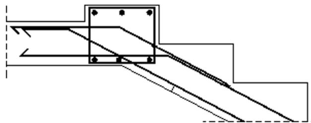
Slika 14. Presjek armirano-betonskog stubišta [11]
