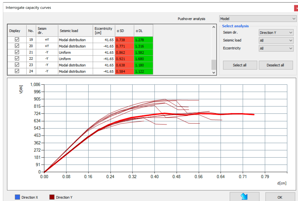
Slika 83. Prikaz „push-over“ krivulje dobivenih rezultata provedenog proračuna za stanje prije potresa za „Y“ smjer
