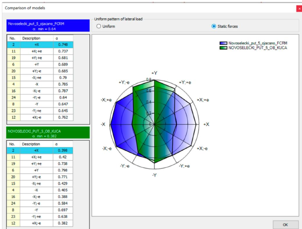
Slika 87. Prikaz usporedbe dobivenih rezultata provedenih proračuna za SD (značajno oštećenje)
