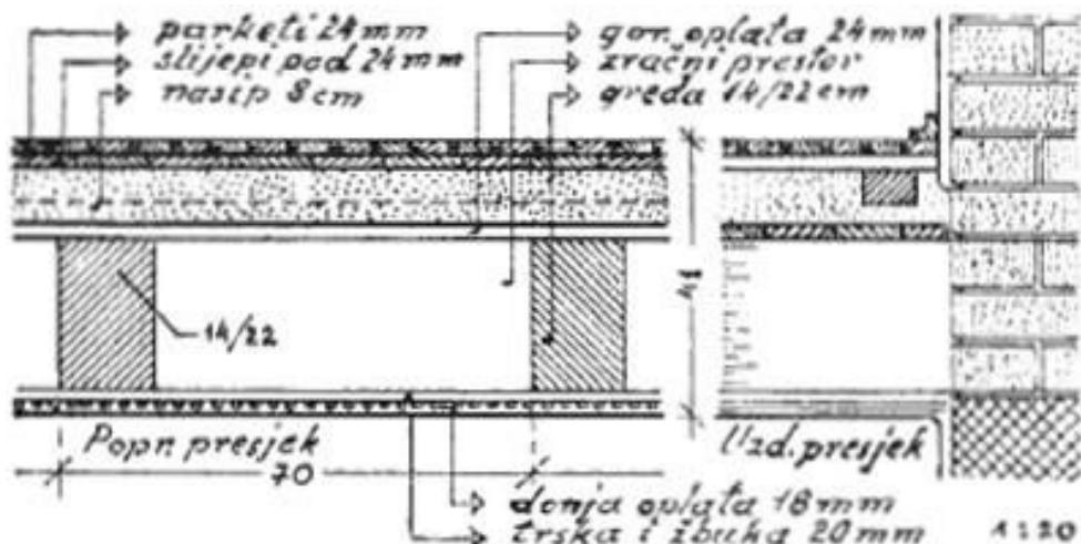
Slika 8. Primjer- presjek drvene međukatne konstrukcije [10]
