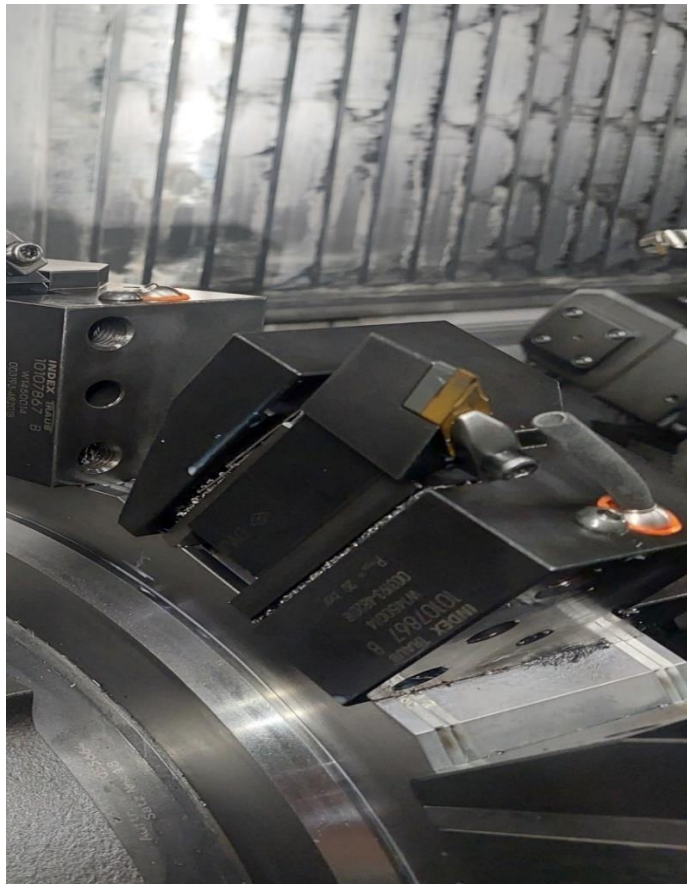
Slika 6.9 Držač „570-DVUNL-40-16“ i pločica „VNMG 16 04 04-QM 4325“
