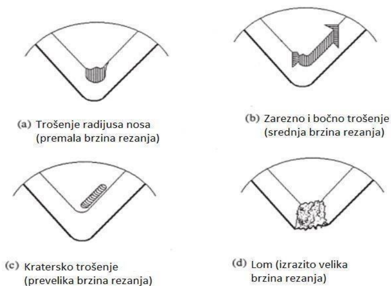
Slika 9.10 Oblici trošenja reznog alata u ovisnosti o brzini [17]
