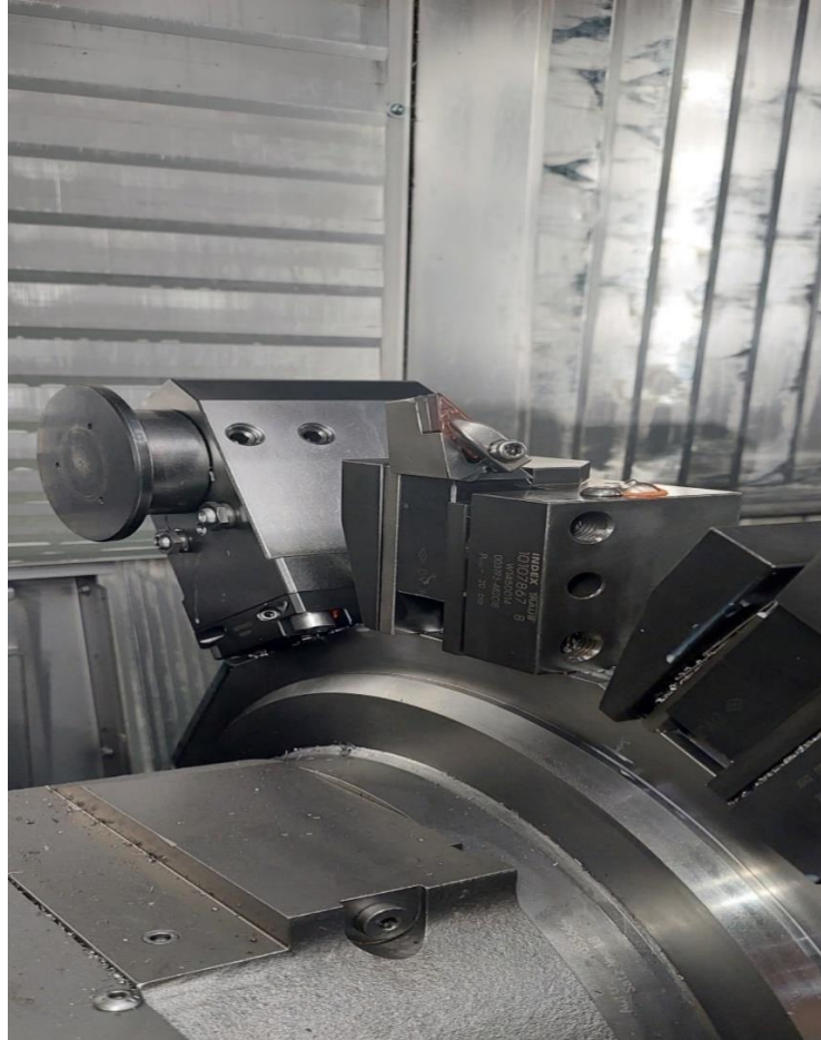
Slika 6.8 Držač „570-DVUNL-40-16“ i pločica „VNMG 16 04 08-MM 1125“
