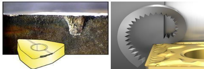
Slika 9.23 Udaranje strugotine u reznu oštricu [10]
