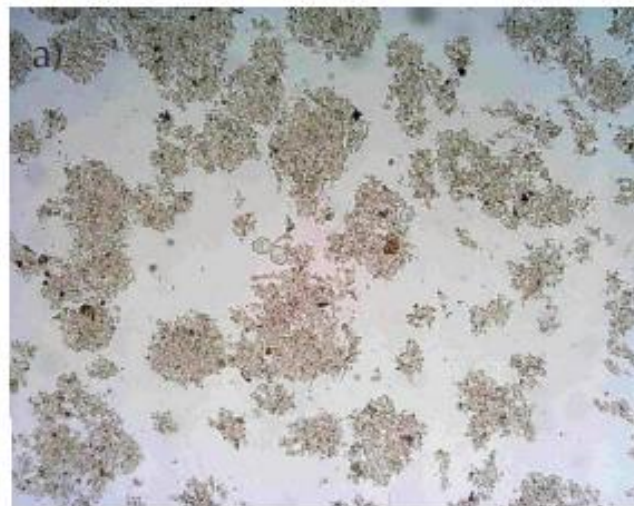
Slika 3.4. Mikrofotografija pahuljica aktivnog mulja, P=100x [13]
