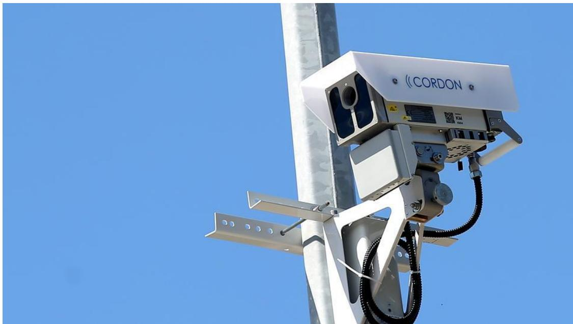
**Slika 7.** Kamera za nadzor brzine
