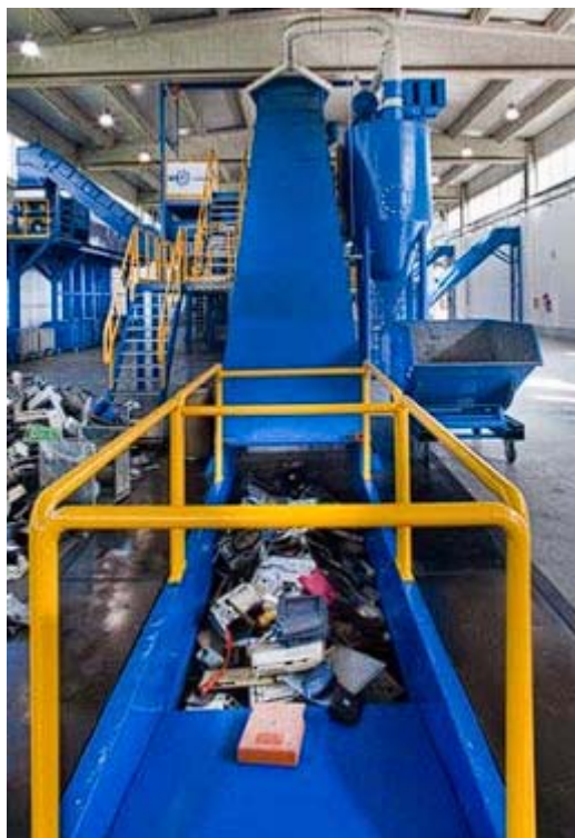
Slika 22. Prikaz stavljanja EE otpada u postrojenje za oporabu [34]
