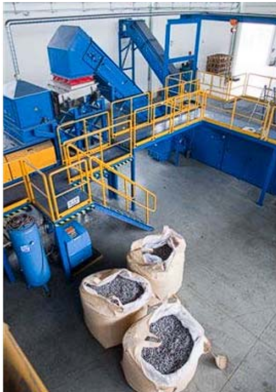
Slika 24. EDDY strujni separator [34]
