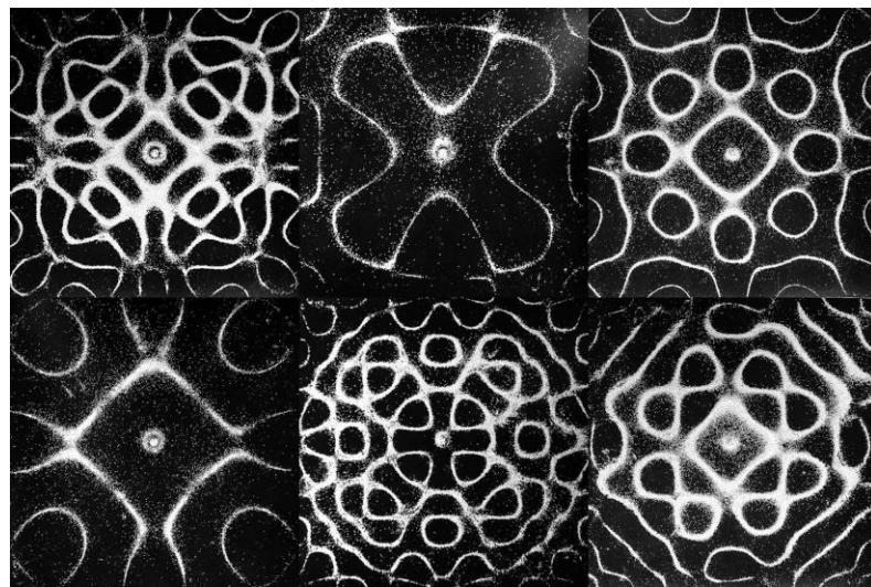
Slika 2. 4: Čestice pjeska na metalnoj ploči nakon izloženosti vibracijama
