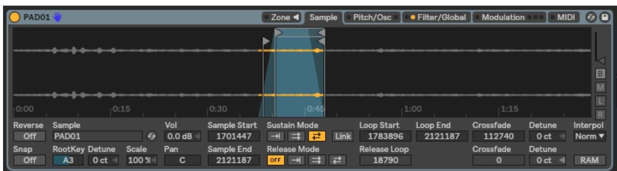
Slika 3. 3: Instrument Sampler sa prikazom učitanog zvuka na kojem je primjenjen loop
