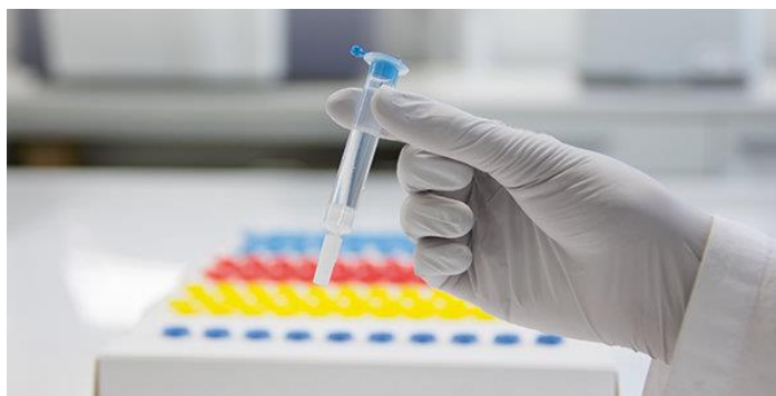
Slika 5: Primjer IAC kolone. Izvor: https://www.viams.net/hr/prodajni-program-hr/mikotoksini/imunoafinitetne-kolone/
