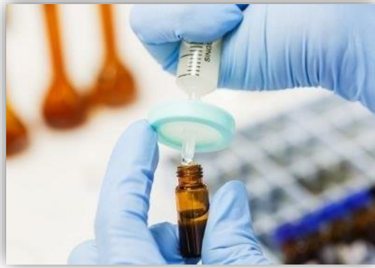
Slika 7: Brizgalice i filteri (lijevo) te filtriranje upotrebom syringe filtera (desno).
