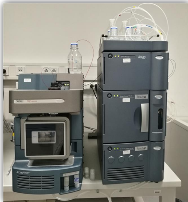
Slika 9: Korišteni LC-MS/MS sustav: Acquity H-classXevo TQ-S micro. Izvor: Waters, SAD
