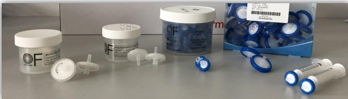
Slika 8: Syringe filteri različitih materijala korišteni za eksperiment. Izvor: autor.
