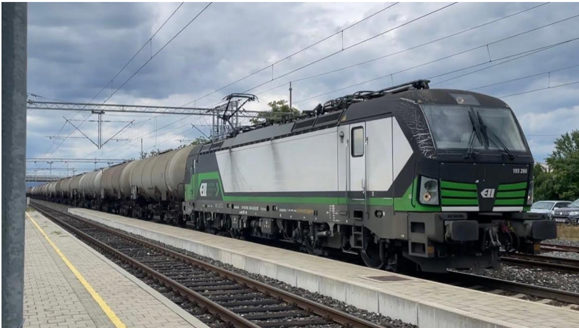
Slika.14: Električna lokomotiva serije 6193
