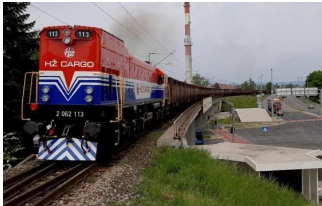
Slika.20: Dizel vučno vozilo serije 2062-100
