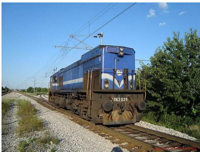
Slika.19: Dizel vučna vozila serije 2062
