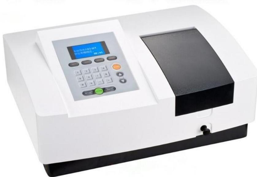
*Slika 15. Spektrofotometrijsko određivanje nitrita*
