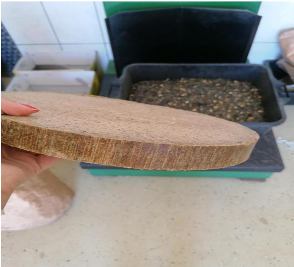
Slika 3.2.7. Pogača od bučinih koštica nakon prešanja, izvor: autor
