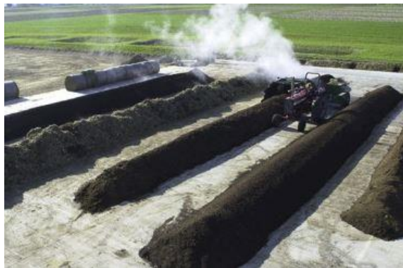
Slika 4. Windrow sustav kompostiranja [18]
