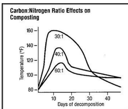
Slika 17. Učinak C:N omjera na proces kompostiranja [27]
