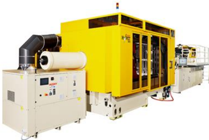
Slika 7-6: Stroj za injekcijsko brizganje (Izvor: https://www.husky.co/en/solutions/systems/ )
