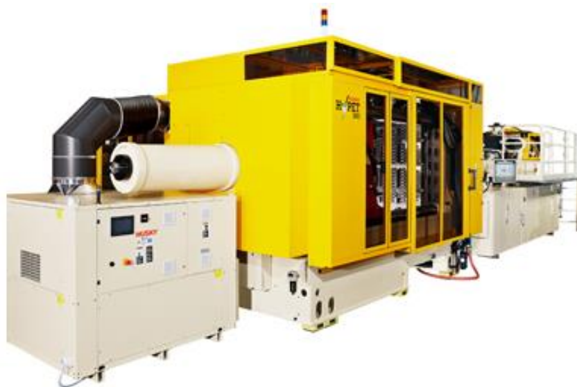
Slika 7-6: Stroj za injekcijsko brizganje (Izvor: https://www.husky.co/en/solutions/systems/ )
