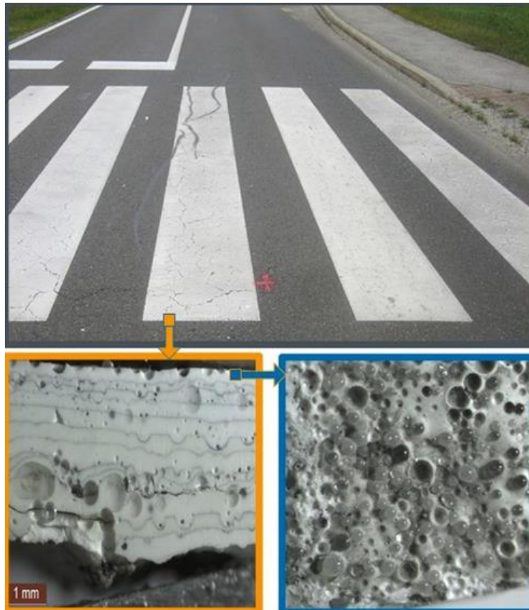
Slika 9. Staklene kuglice u oznakama na cesti
