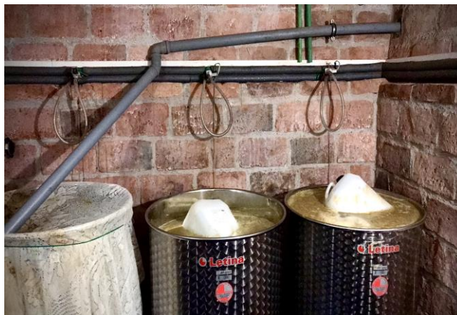
Slika 12. Transport mošta u inox bačve i hlađenje
