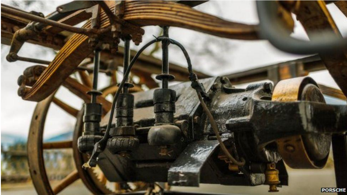
Slika 7. Osmerokutni električni motor koji je dizajnirao Ferdinand Porsche
