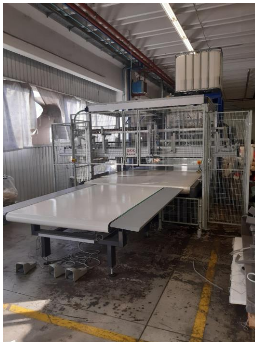
Slika 2.3. Linija za lijepljenje ljepilom na bazi vode [autor]
