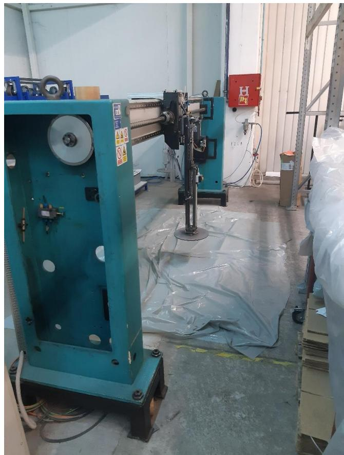
Slika 4.10.2.2 Stroj za ispitivanje čvrstoće madraca [autor]
