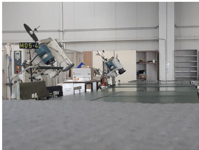
Slika 2.1.6 Tape edge šivaće mašine [autor]
