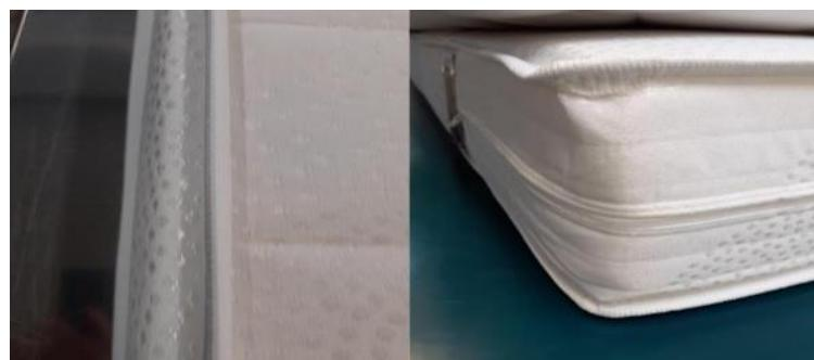
Slika 4.10.2 Primjer neusklađenosti navlake i rohlinga [8]
