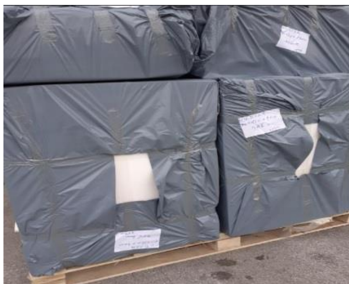
Slika 3.3.2 Primjer neispravno zapakirane pjene [8]
