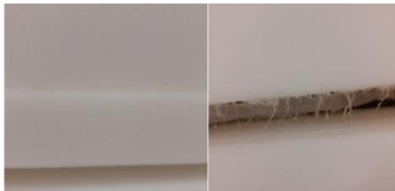
Slika 4.5.1 Primjer ispravnog spoja (lijevo) i neispravnog spoja (desno) [8]
