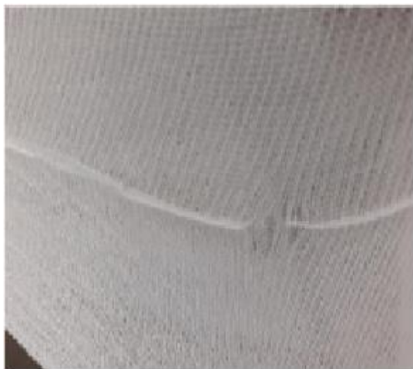
Slika 4.8.1 Primjer nedostatka niti [8]
