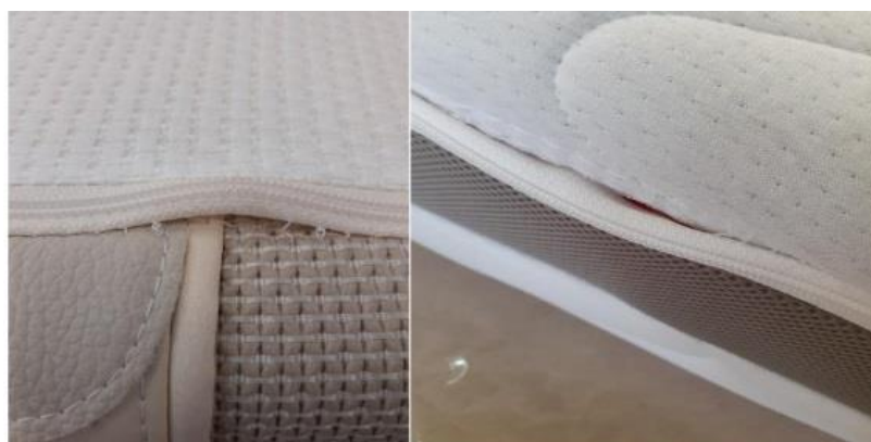
Slika 4.10.3 Primjer neispravnih šavova [8]
