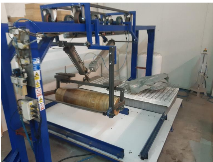
Slika 4.10.2.1 Stroj za valjanje madraca [autor]
