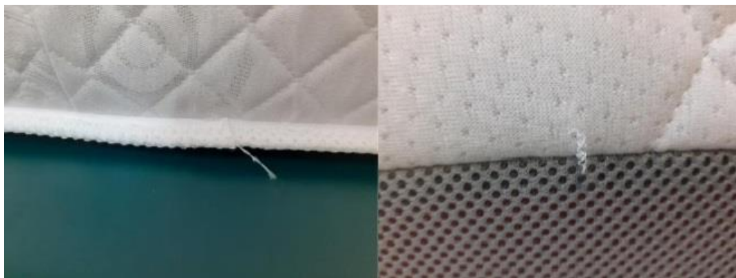
Slika 4.10.1 Primjer viška konca (lijevo) i izvučenog konca (desno) [8]
