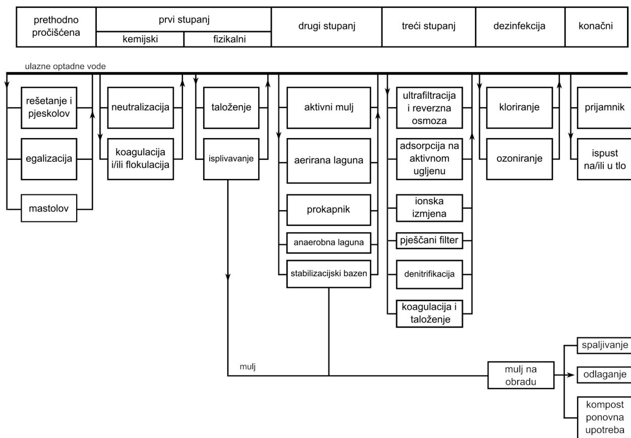
Slika 1: Dijelovi tehnološke linije pročišćavanja otpadnih voda [4]
