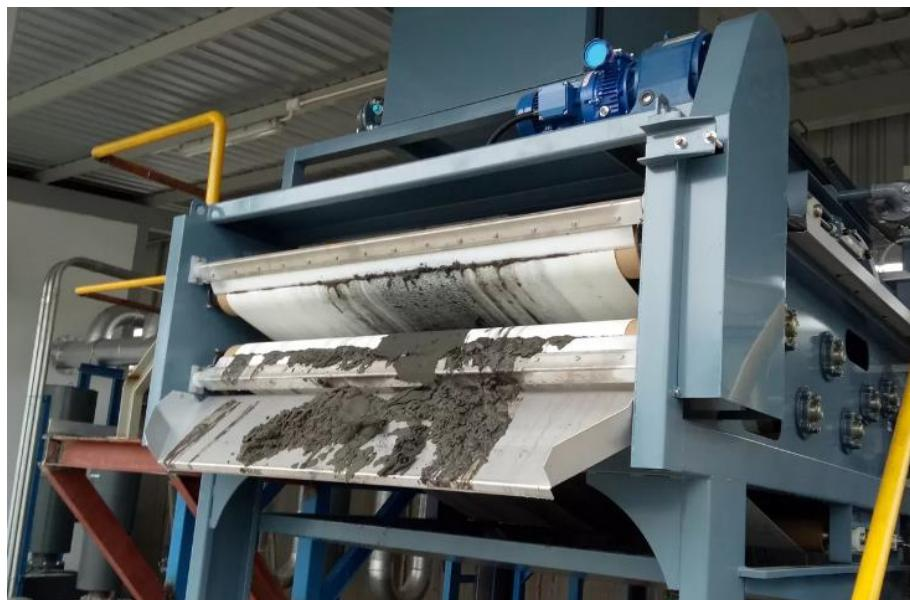
Slika 12: Dehidracija mulja pomoću trakaste filter preše [16]
