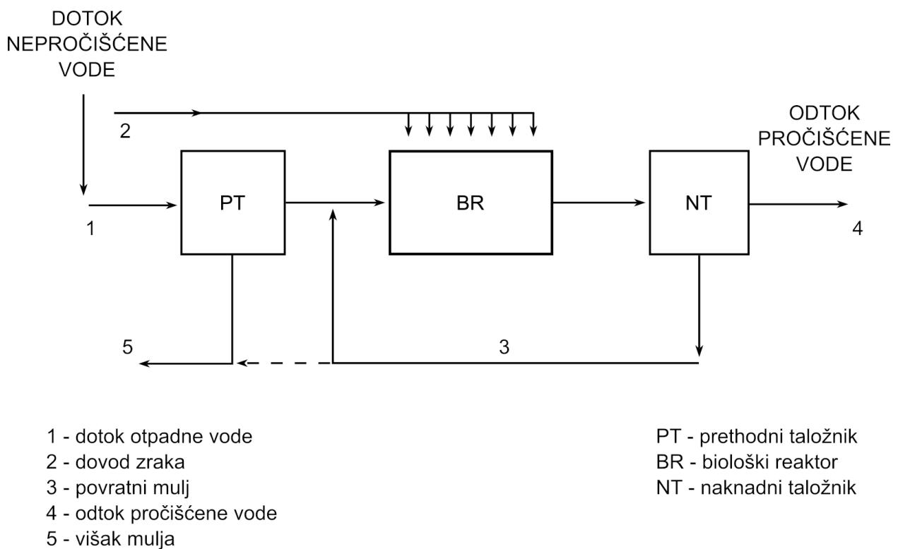
Slika 5: Shema konvencionalnog postupka s aktivnim muljem [4]
