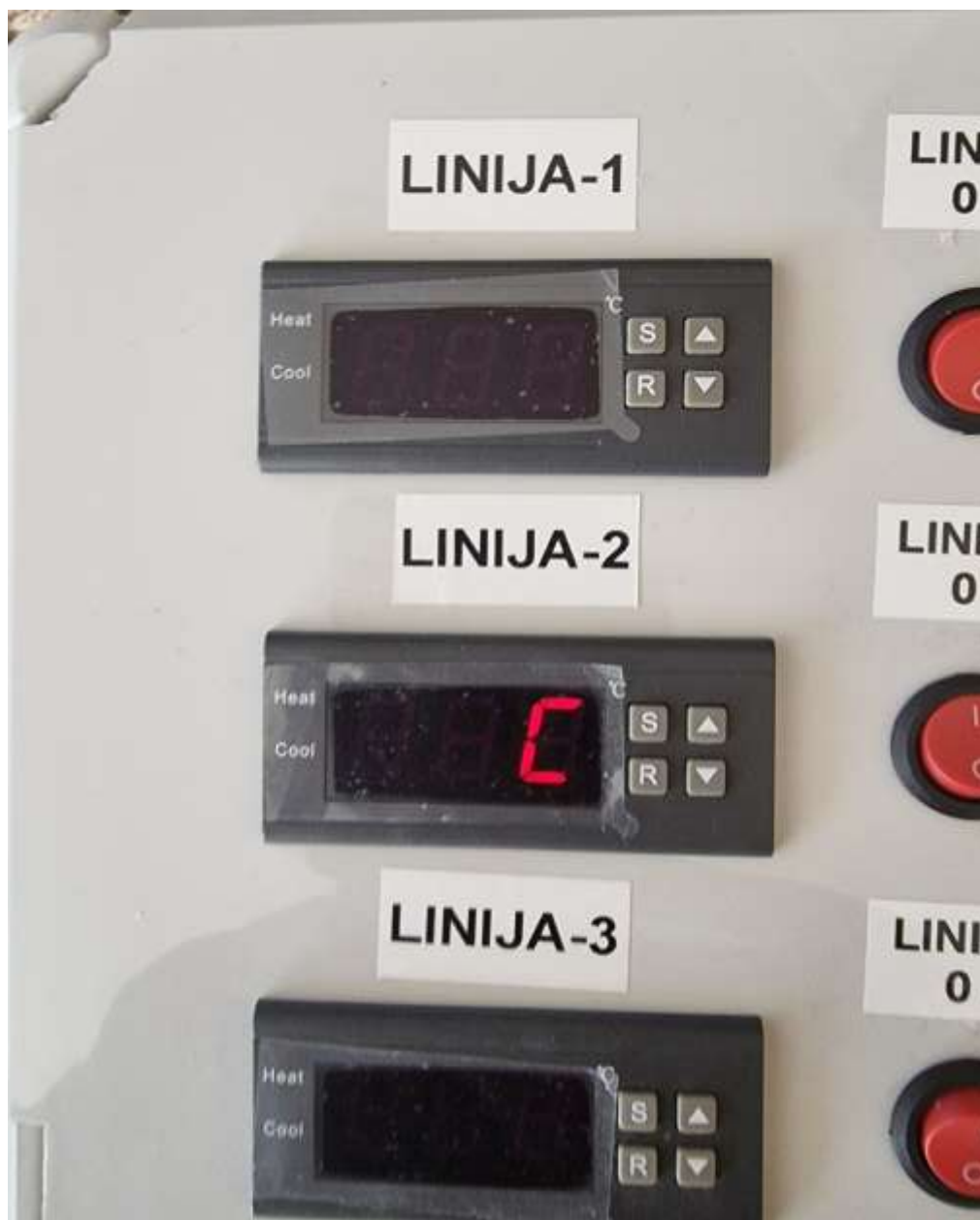
Slika 6.3. Podešavanje hlađenja ili grijanja
