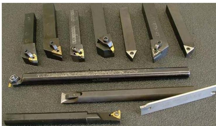
Slika 5.3 Tokarski noževi s izmjenjivom reznom pločicom [12]
