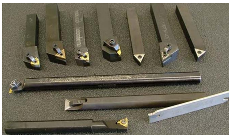
Slika 5.3 Tokarski noževi s izmjenjivom reznom pločicom [12]
