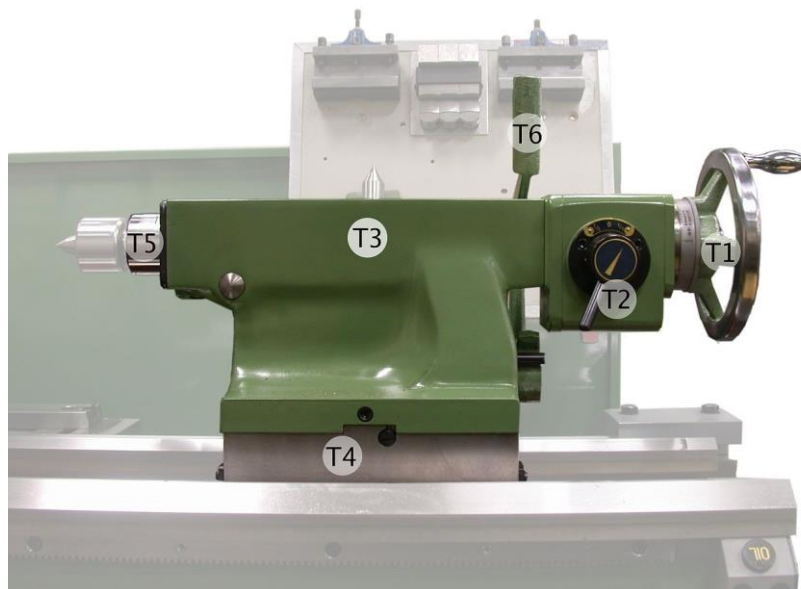
Slika 4.11 Konjić sa steznim šiljkom [19]
