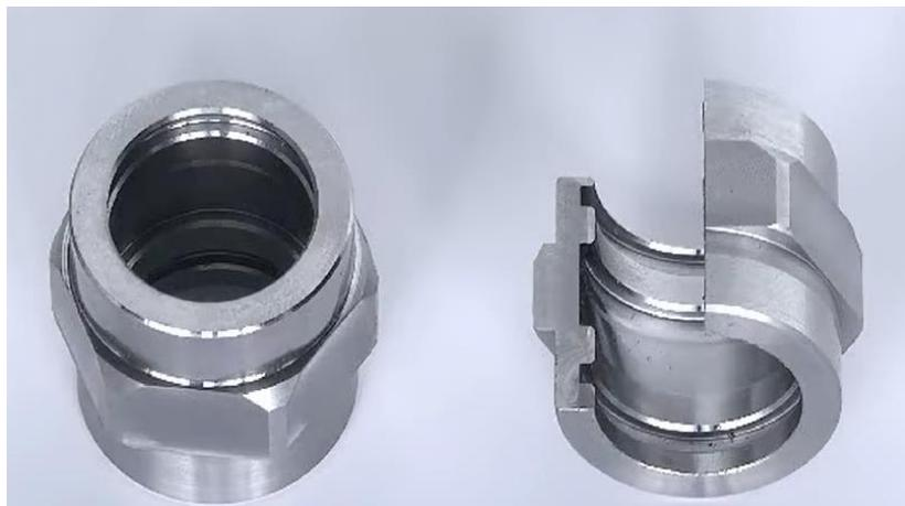
*Slika 6.12 Proizvod izrađen višefunkcijskim alatom Iscar DRG-MF [41]*
