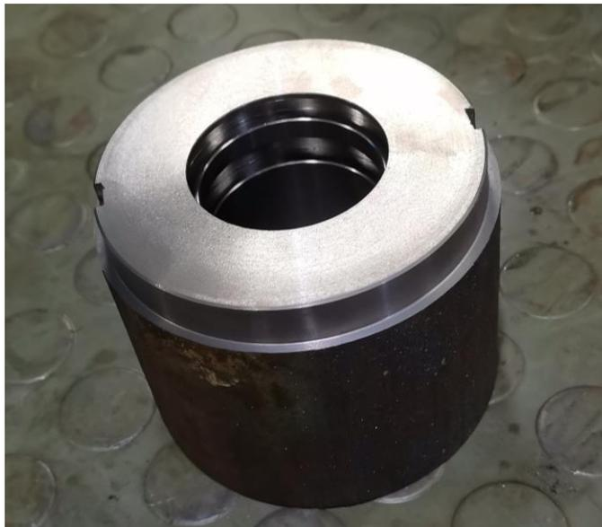
*Slika 5.28; Obrada glave cilindra u jednom stezanju [autor - 22.04.2022.]*
