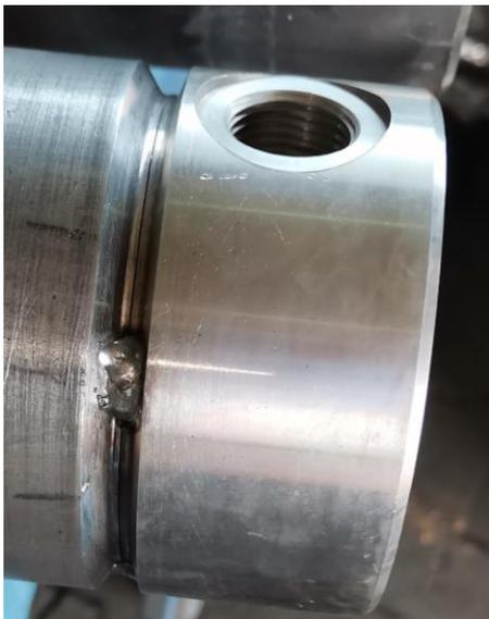
*Slika 5.43; Postupak zavarivanja dna i cijevi cilindra [autor - 17.05.2022.]*
