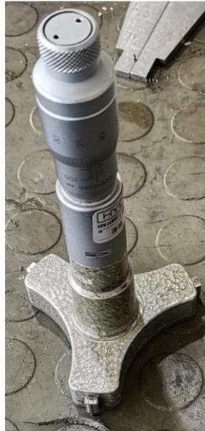
*Slika 5.30; Mikrometar za unutarnje mjerenje [autor - 22.04.2022.]*
