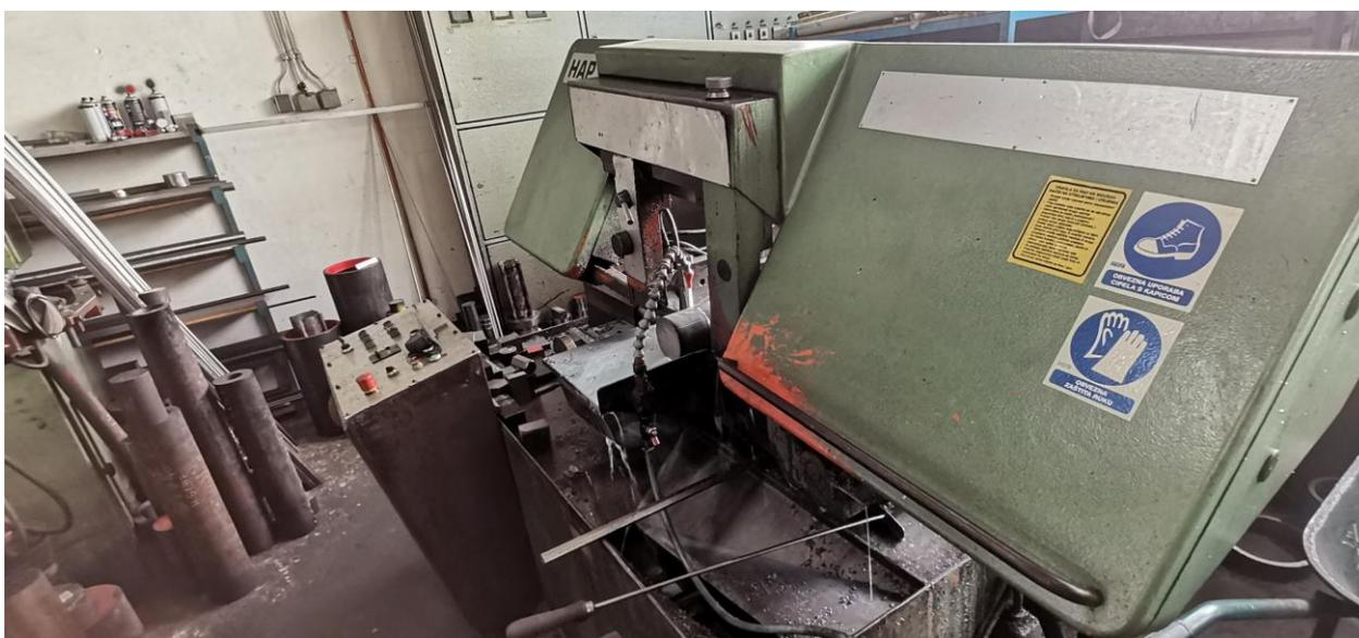
*Slika 5.25; Horizontalna tračna pila HAP 280 [autor – 21.04.2022.]*
