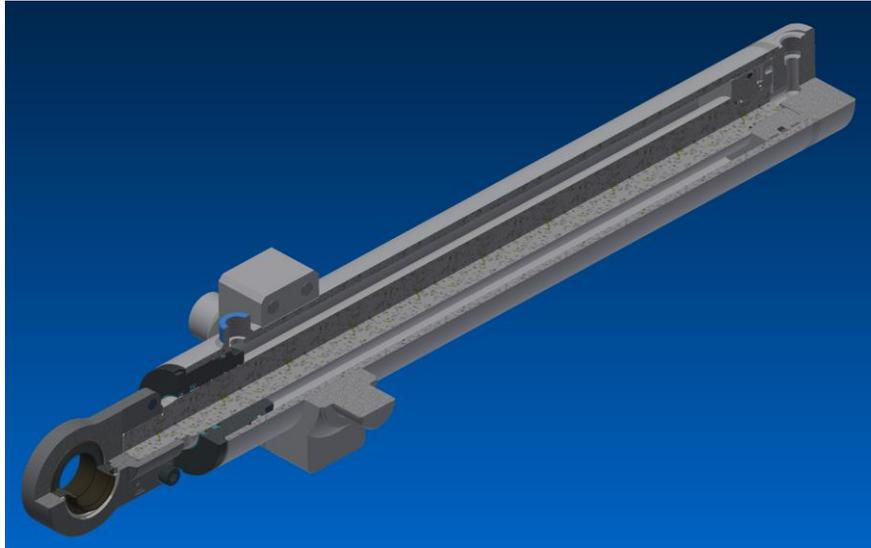
*Slika 5.23; 3D montažni presjek modela hidrauličkog cilindra [8]*
