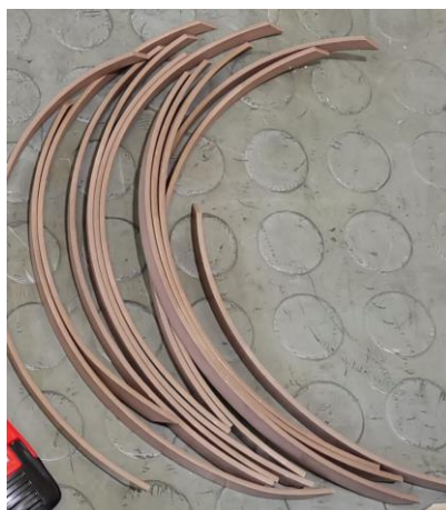
Slika 5.56; Klizači izrezani na duljinsku dimenziju 250 mm [autor -19.05.2022.]
