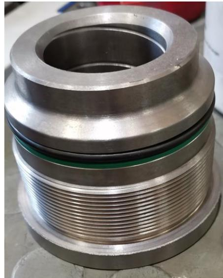
*Slika 5.54; Glava cilindra sa montiranim O-ringom i potpornim prstenom O-ringa [autor - 19.05.2022.]*
