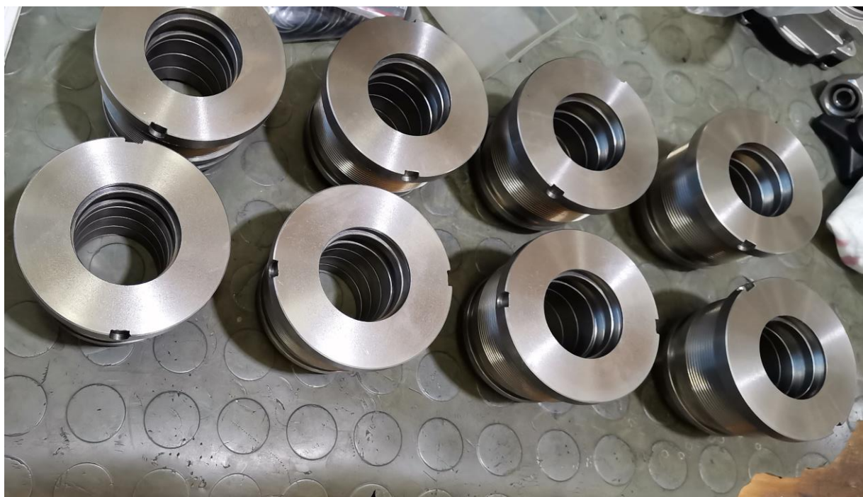
Slika 5.45; Glave cilindara neposredno prije montaže [autor - 19.05.2022.]
