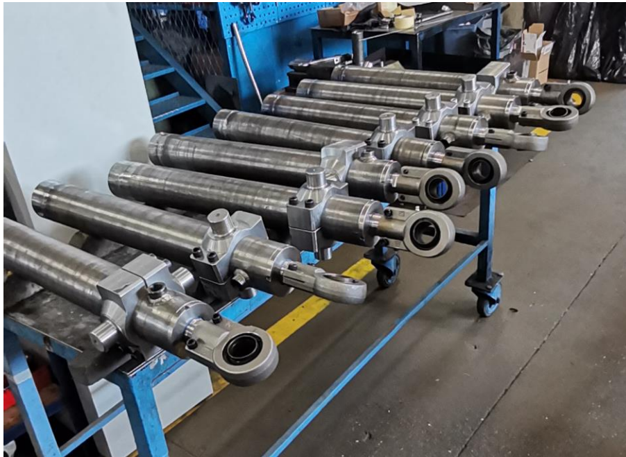
Slika 5.58; 8 hidrauličkih cilindara nakon postupka montaže [autor - 20.05.2022.]
