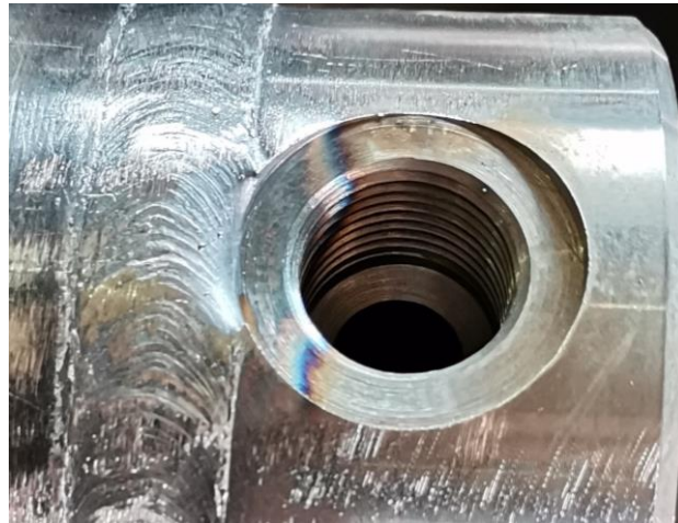
Slika 5.60; Kritično mjesto zavarivanja [autor - 17.05.2022.]
