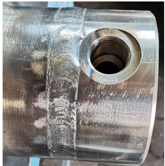
Slika 5.44; Zavareno dno i cijev cilindra [autor - 17.05.2022.]
