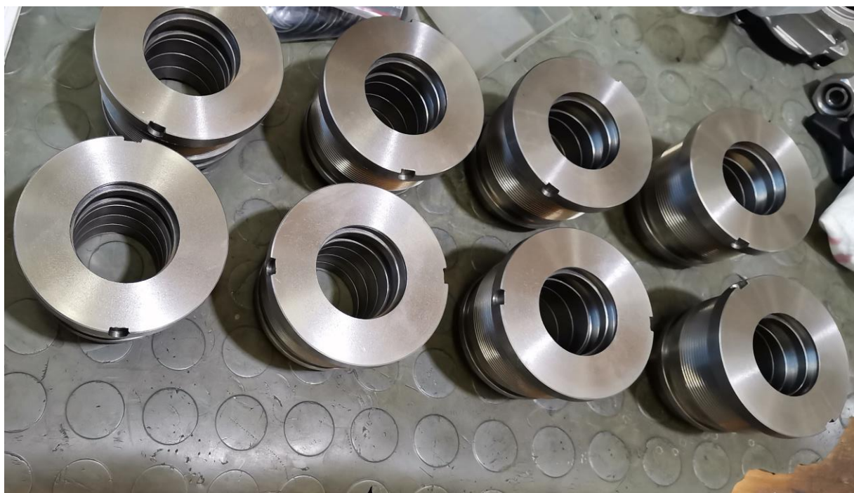
Slika 5.45; Glave cilindara neposredno prije montaže [autor - 19.05.2022.]
