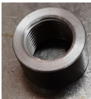
Slika 5.6; Zavareni priključak cilindra 1/2" [autor - 21.04.2022.]
