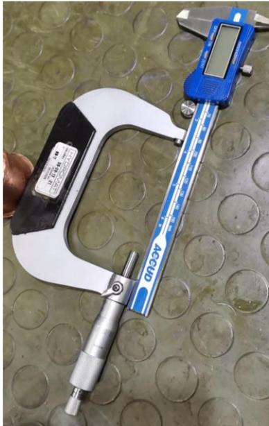
*Slika 5.29; Mikrometar i pomično mjerilo [autor - 22.04.2022.]*
