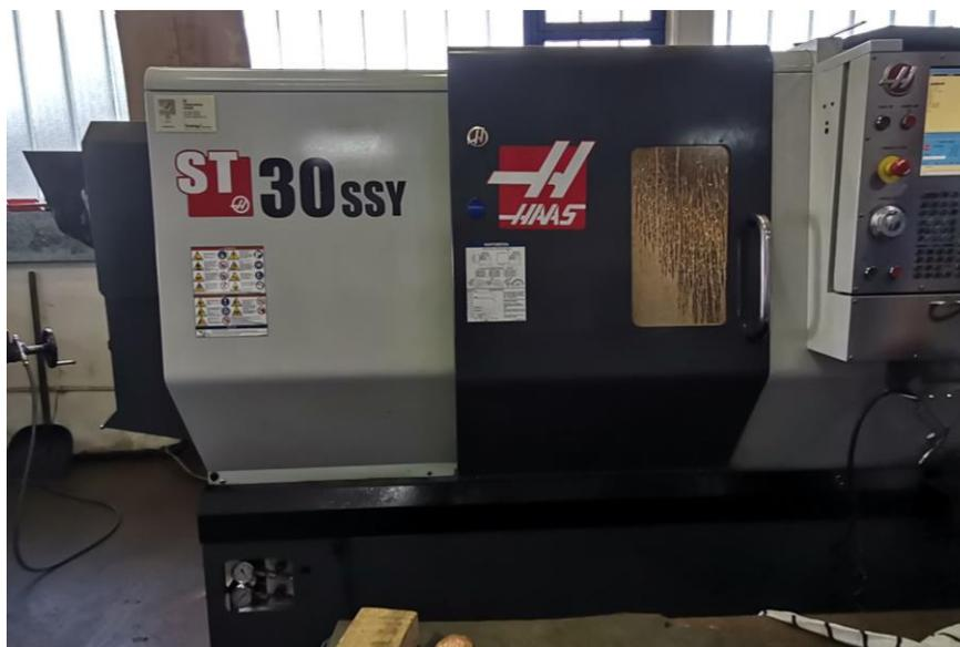
*Slika 5.35; Tokarski obradni centar HAAS ST 30 SSY [autor - 21.04.2022.]*
