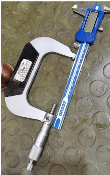
*Slika 5.65; Mikrometar i pomično mjerilo [autor - 22.04.2022.]*
