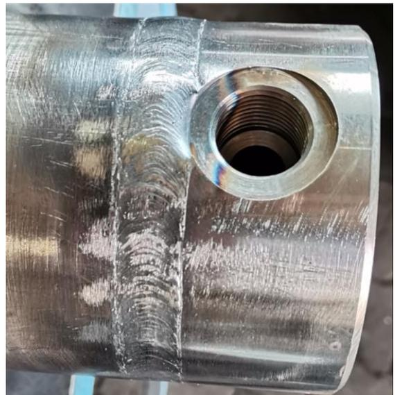
*Slika 5.44; Zavareno dno i cijev cilindra [autor - 17.05.2022.]*
