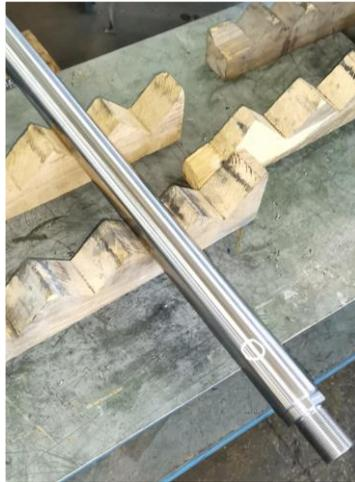
*Slika 5.63; Oštećenje klipnjače [autor - 19.05.2022.]*
