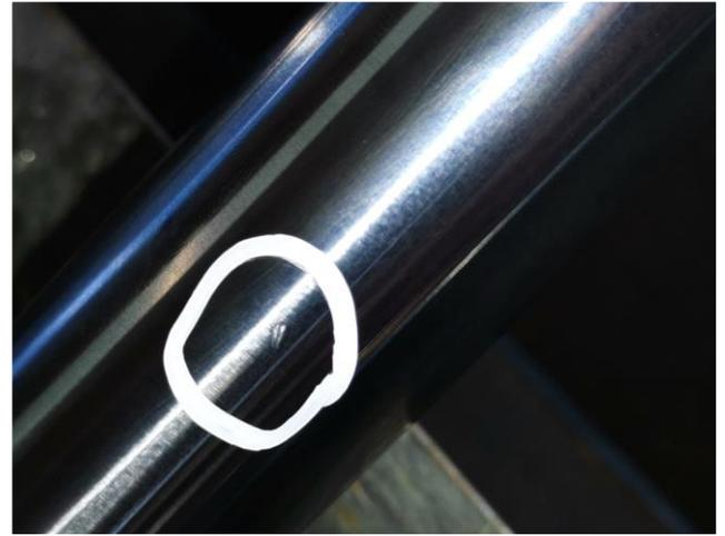
*Slika 5.64; Naznačeno oštećenje klipnjače [autor - 19.05.2022.]*
