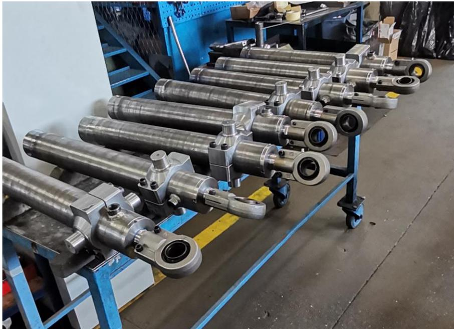
*Slika 5.58; 8 hidrauličkih cilindara nakon postupka montaže [autor - 20.05.2022.]*
