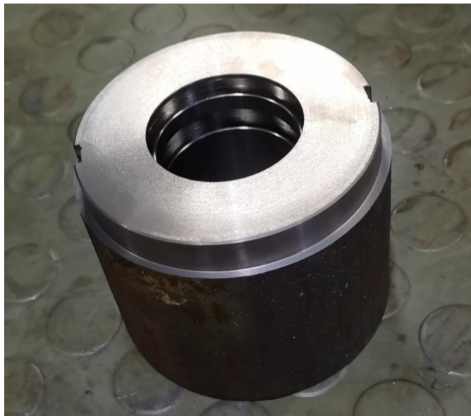
Slika 5.28; Obrada glave cilindra u jednom stezanju [autor - 22.04.2022.]
