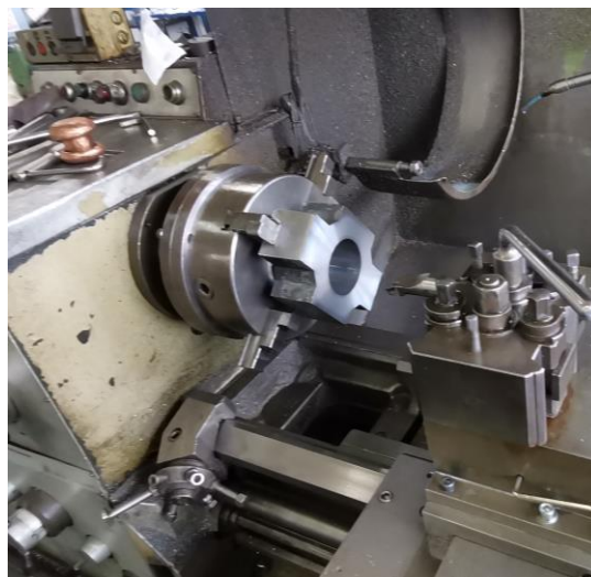
Slika 5.42; Obrada oscilirajućeg prihvata MT4 na tokarilici PRVOMAJSKA TVP 300 [autor - 27.04.2022.]
