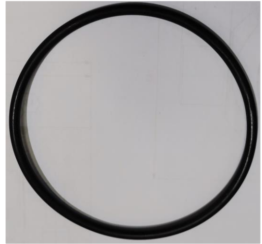
Slika 5.51; O-ring glave cilindra [autor - 19.05.2022.]
