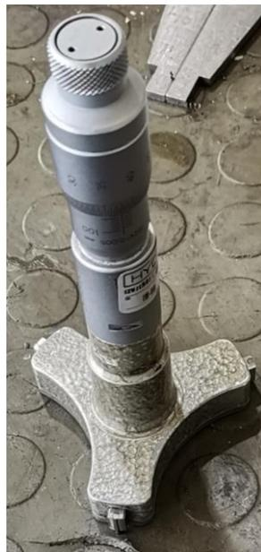
*Slika 5.66; Mikrometar za unutarnje mjerenje [autor - 22.04.2022.]*
