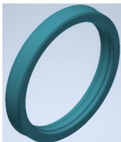
*Slika 5.18; 3D model brtve klipnjače [autor - 21.04.2022.]*
