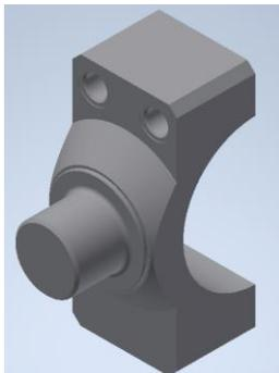
*Slika 5.7; 3D model oscilirajućeg prihvata MT4 [autor - 21.04.2022.]*
