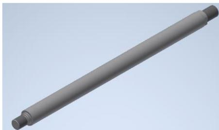
*Slika 5.3; 3D model klipnjače [autor - 21.04.2022.]*
