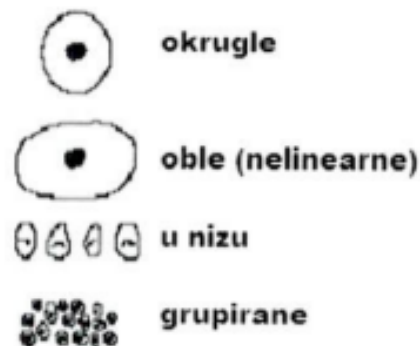
Slika 4.28 Tipovi točkastih indikacija [10]
