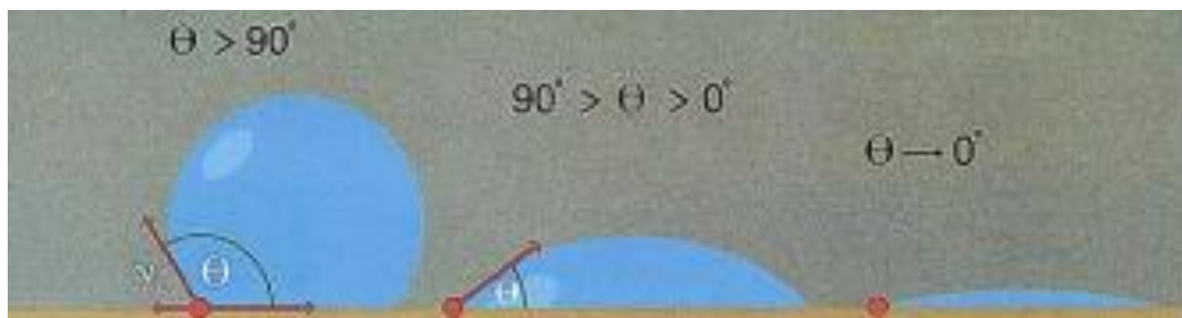
Slika 4.10 Sposobnost moćenja penetranta s obzirom na kontaktni kut [10]
