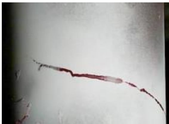
Slika 4.7 Obojeni penetrant pod bijelim svjetlom [10]
