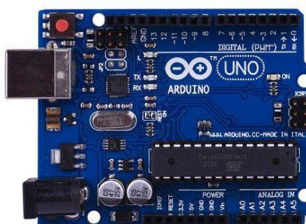
Slika 4.1. Arduino UNO mikroupravljač
