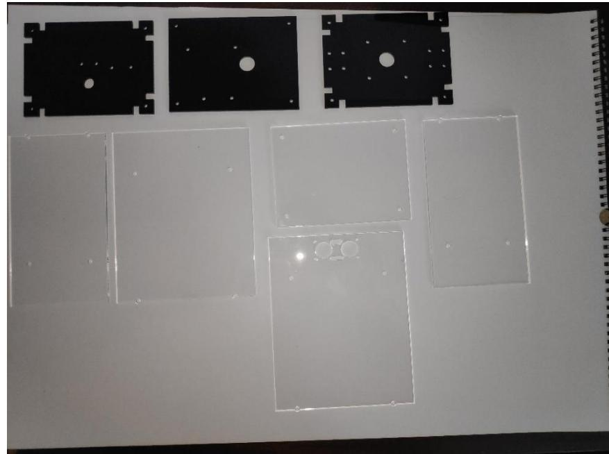
Slika 3.2. Izrezani dijelovi kućišta od akrilnih ploča
