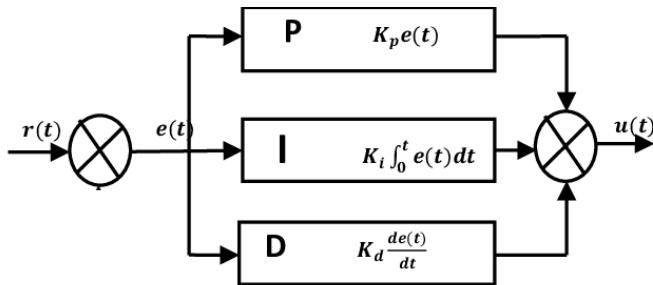
Slika 10.1. Shema PID regulatora [15]
