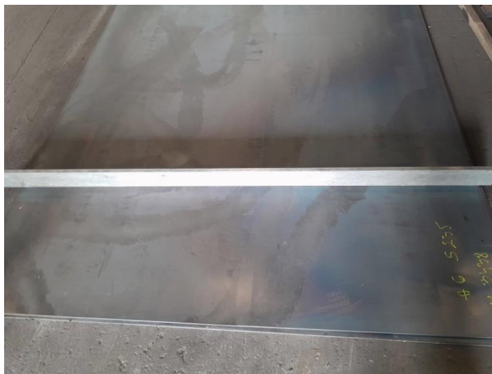
Slika 5.1. Ulazna kontrola ravnosti i dimenzija pristiglog lima[19]
