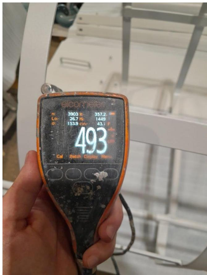
Slika 2.4. Kontrola nanosa antikorozivne zaštite [19]
