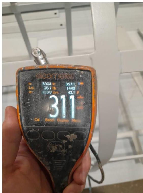
*Slika 5.7. „Elcometer“ uređaj za mjerjenje debljine suhog filma[19]*
