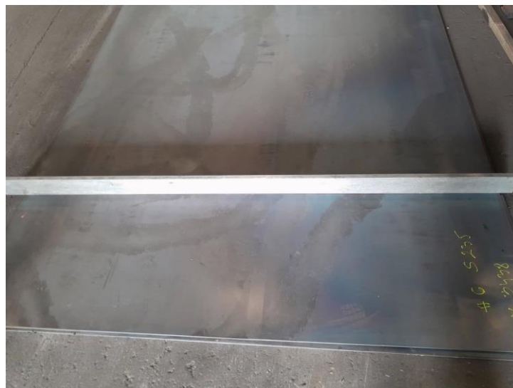
Slika 5.1. Ulazna kontrola ravnosti i dimenzija pristiglog lima[19]
