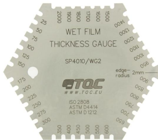
Slika 5.6. Češalj za mjerenje mokrog filma [29]
