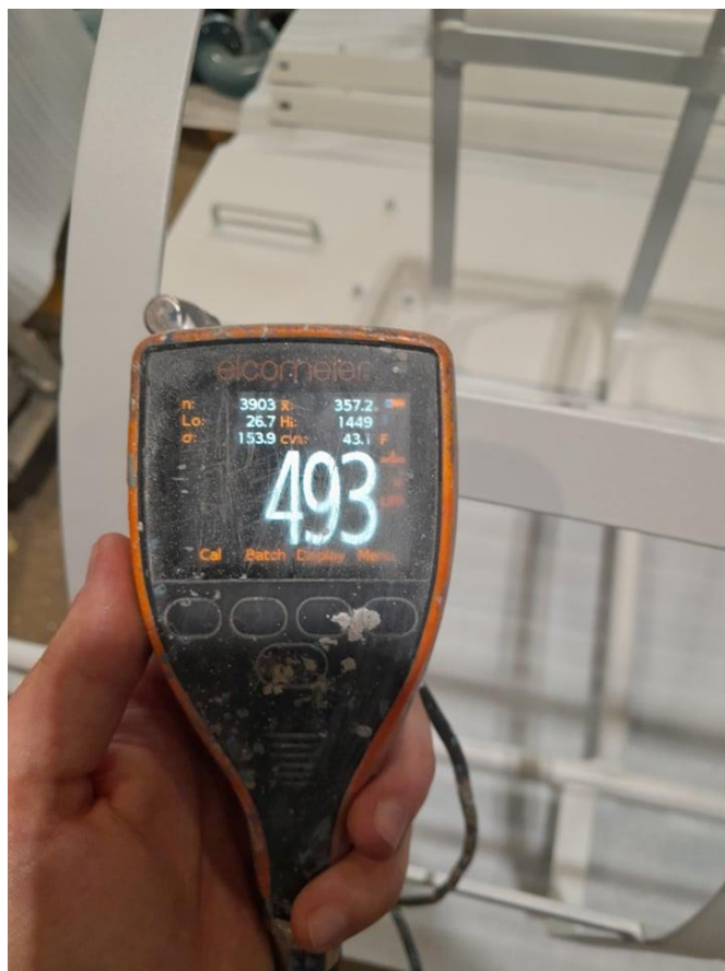
Slika 2.4. Kontrola nanosa antikorozivne zaštite [19]
