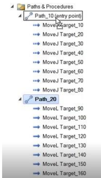
Slika 8.9. 'prebacivanje' putanje zavarivanja u glavnu putanju
