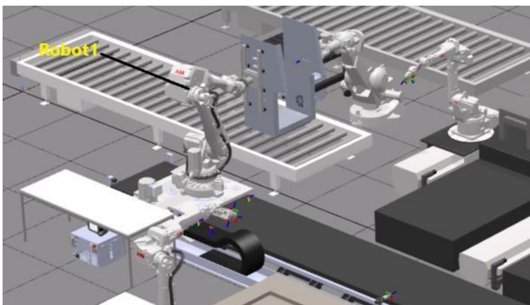
Slika 3.3. Robot1 preuzima tijelo dijalizatora
