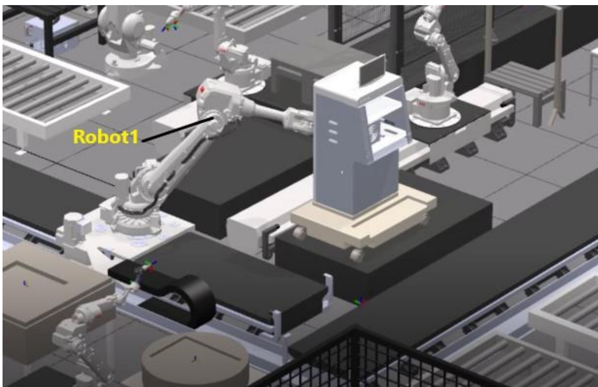
Slika 3.14. Robot1 postavlja stražnju ploču
