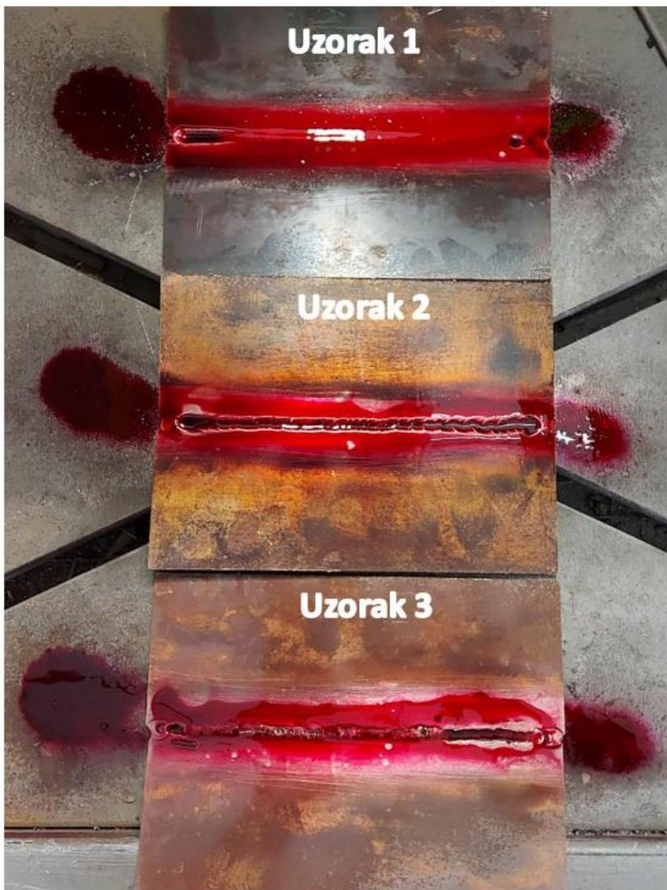
*Slika 5.12 Nanošenje crvenog penetranta na uzorke*
