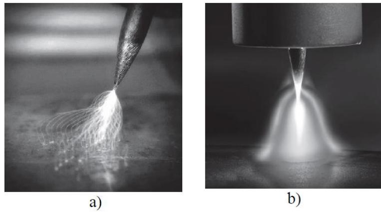
*Slika 3.2 a) Uspostava električnog luka, b) Električni luk [7]*
