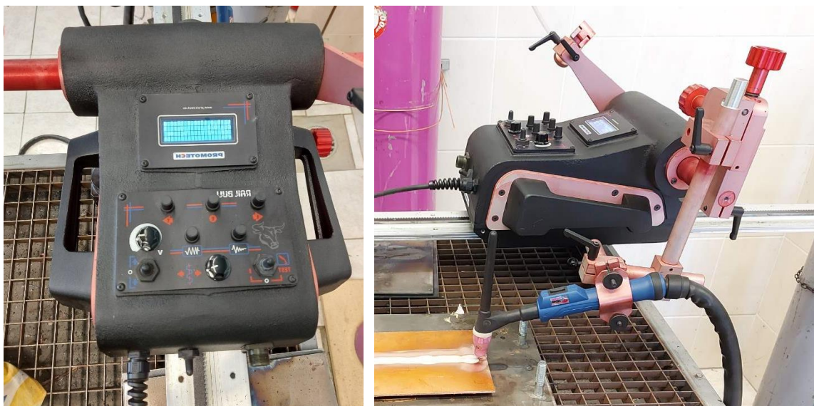
Slika 5.6 Uređaj RAIL BULL za automatizirano zavarivanje
