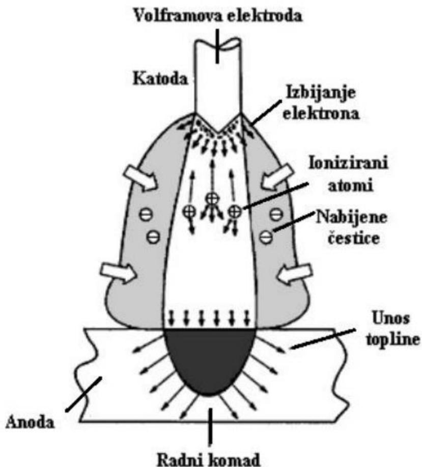
*Slika 4.3 Mehanizam kontrakcije električnog luka [25]*
