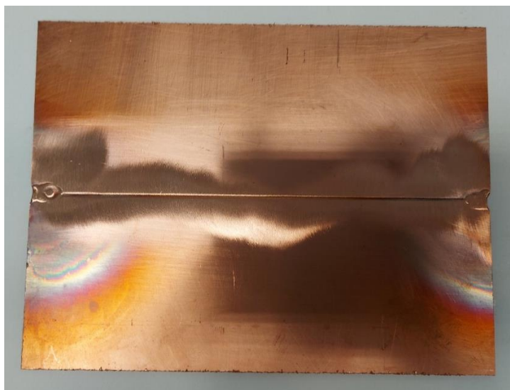
Slika 5.7 Uzorak pripremljen za zavarivanje
