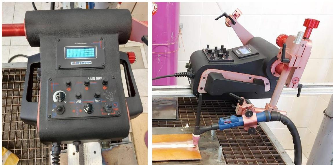
Slika 5.6 Uređaj RAIL BULL za automatizirano zavarivanje
