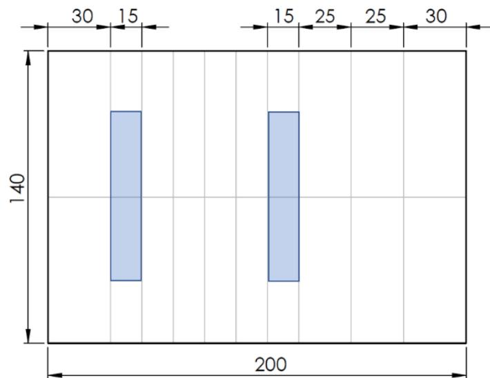
Slika 5.14 Plan rezanja uzorka za makro izbrusak
