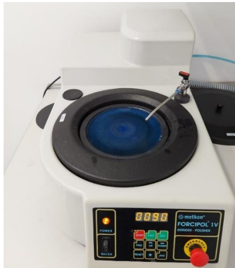
Slika 5.16 Brusilica Forcipol IV, marke Metkon
