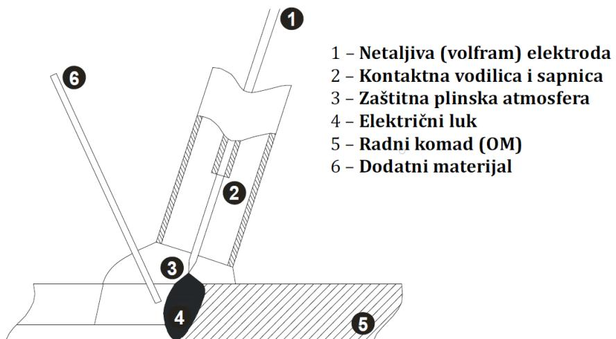
Slika 3.1 Shematski prikaz procesa TIG zavarivanja [7]
