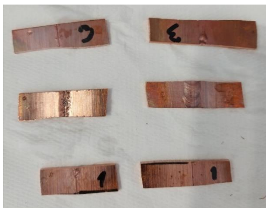
Slika 5.15 Izrezani uzorci za makro izbrusak
