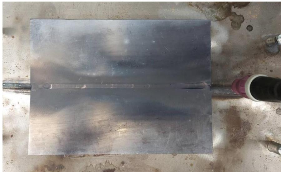
Slika 5.8 Uzorak 1 nakon zavarivanja
