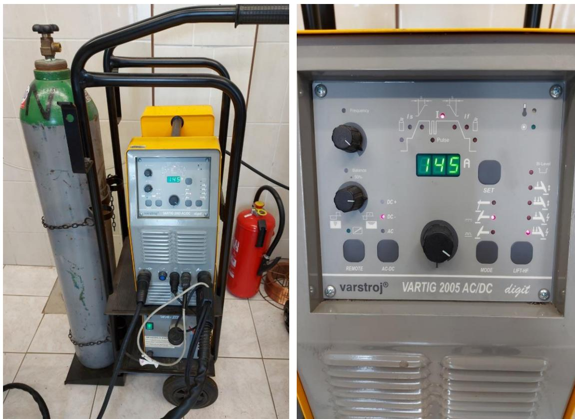
Slika 5.1 Varstroj VARTIG 2005 AC/DC uređaj za zavarivanje
