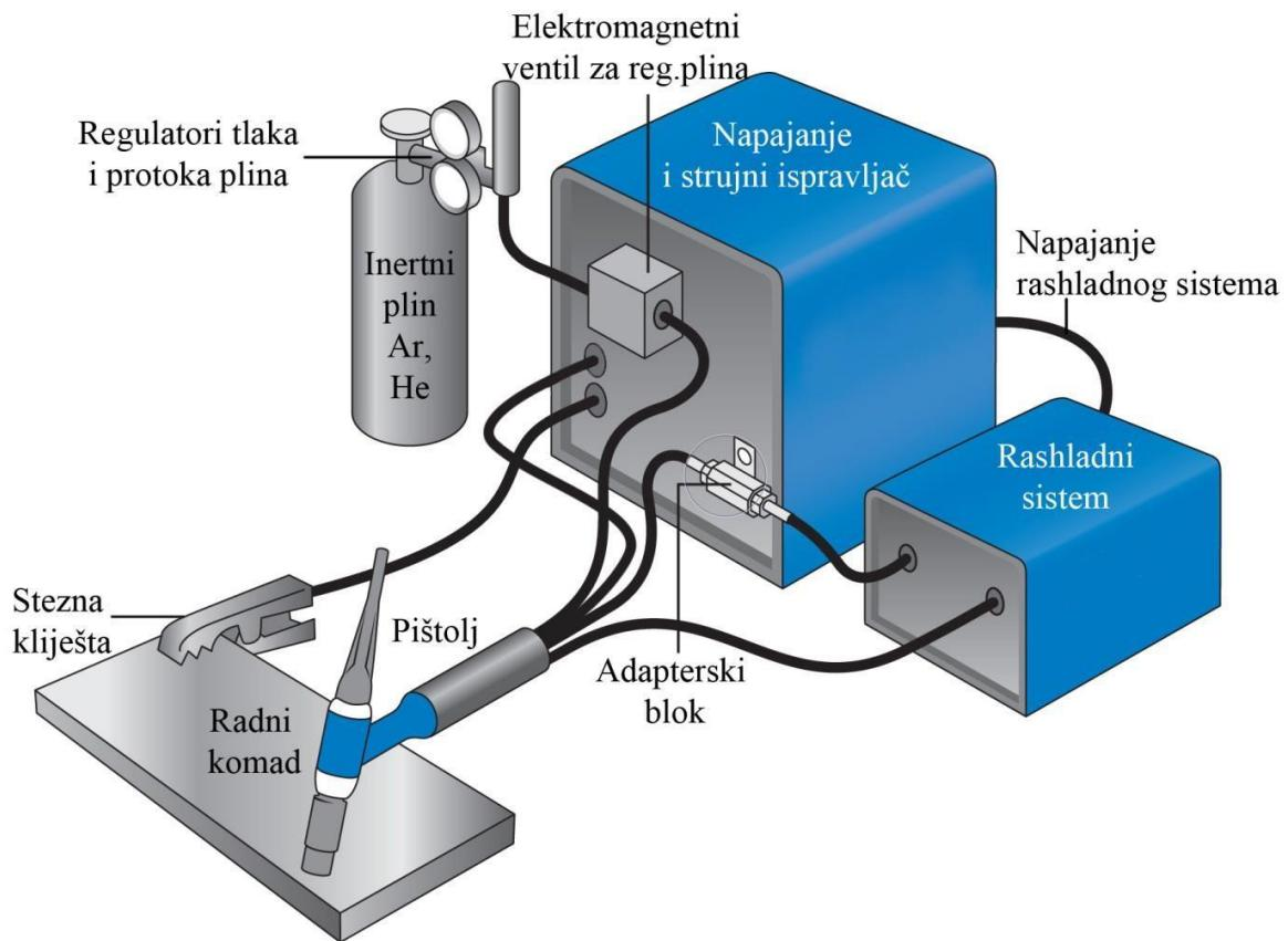
Slika 3.4 Osnovna oprema za TIG zavarivanje [12]
