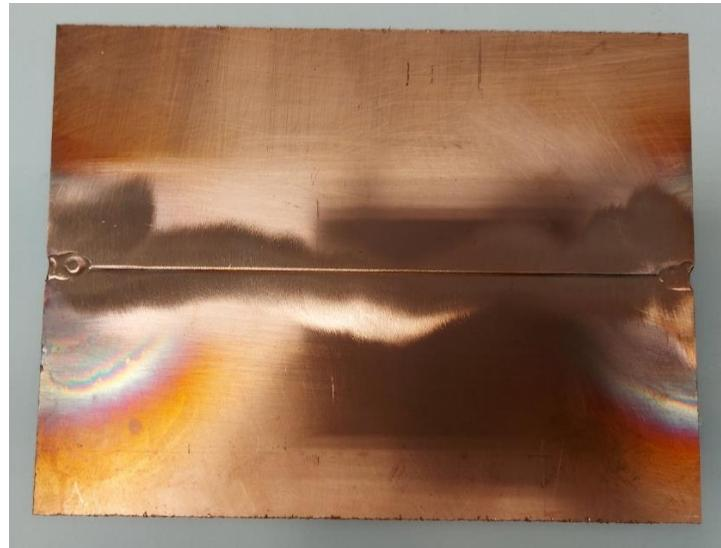
Slika 5.7 Uzorak pripremljen za zavarivanje
