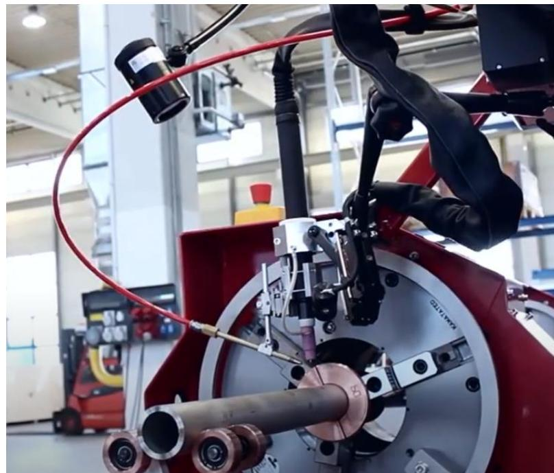
Slika 3.11 Automat za automatizirano TIG zavarivanje [28]
