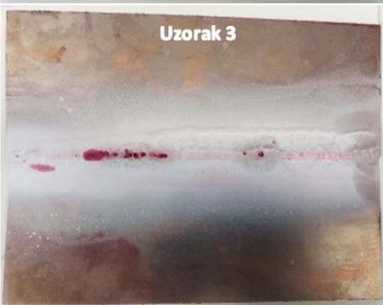
*Slika 5.13 Rezultati ispitivanja penetrantima*
