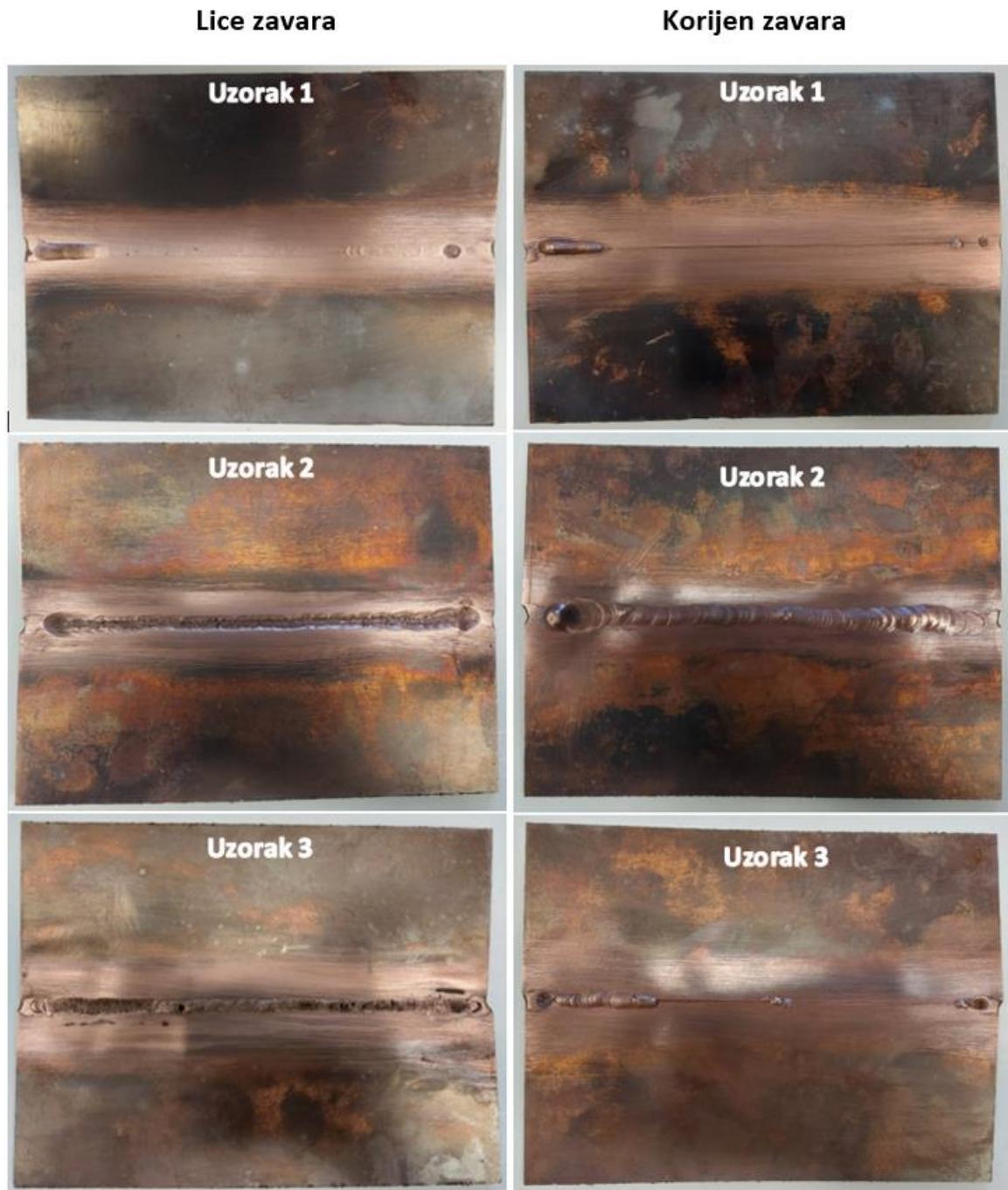
Slika 5.11 Prikaz lica i korijena zavara nakon čišćenja uzorka
