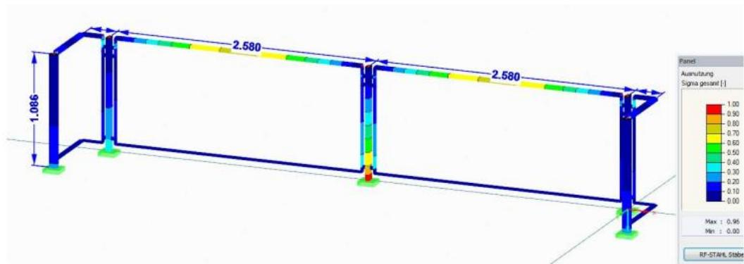
Slika 46: Naprezanje u stupovima s razmakom 2580 mm [11]
