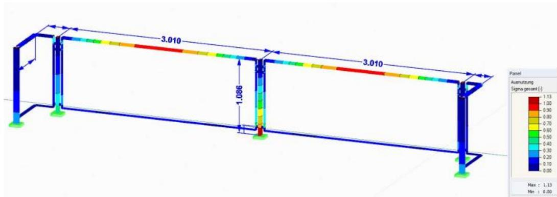
Slika 48: Naprezanje u stupovima s razmakom 3010 mm [11]
