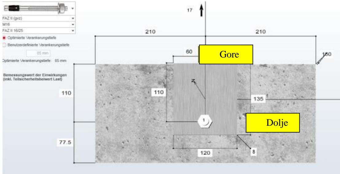
Slika 44: Bočno pričvršćenje vijak anker M16 [11]
