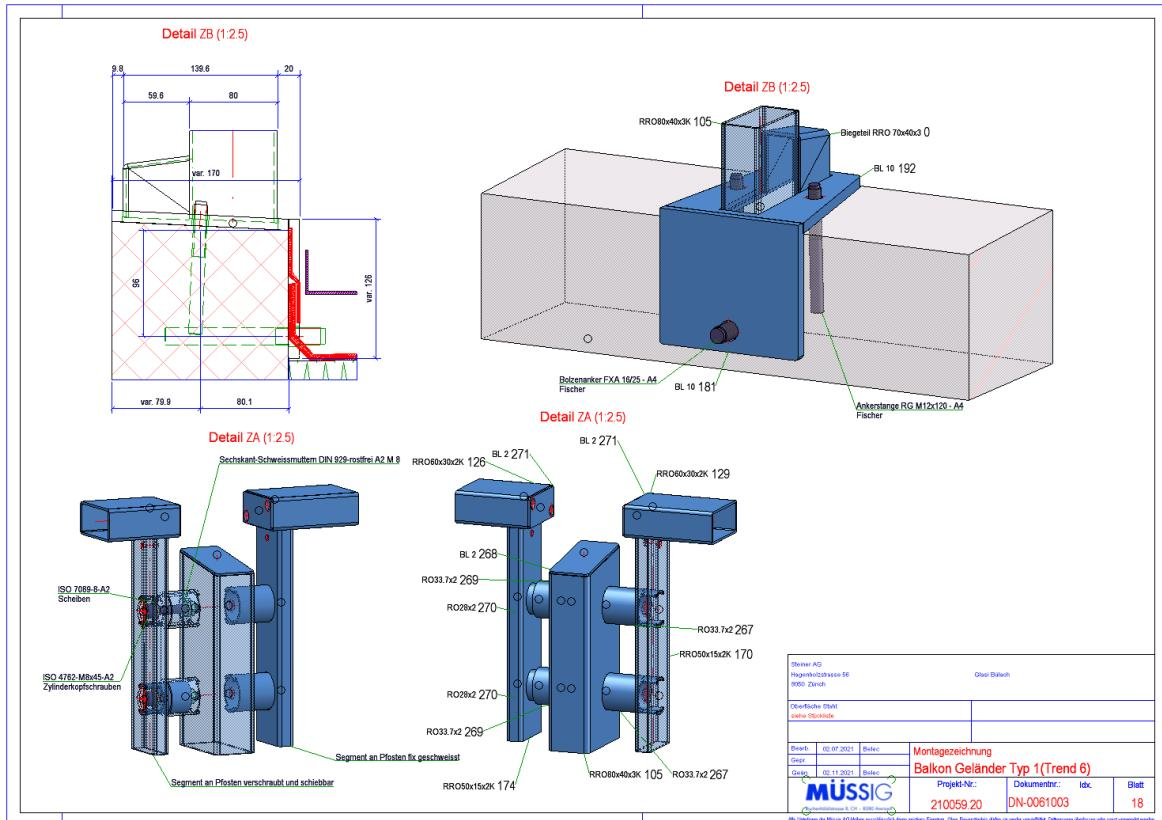
Slika 16: Plan montaže balkonske ograda 3 [11]
