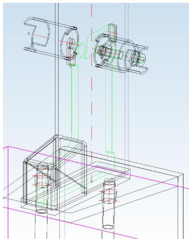
Slika 53: Metalno ojačanje integrirano u dno stupa [11]
