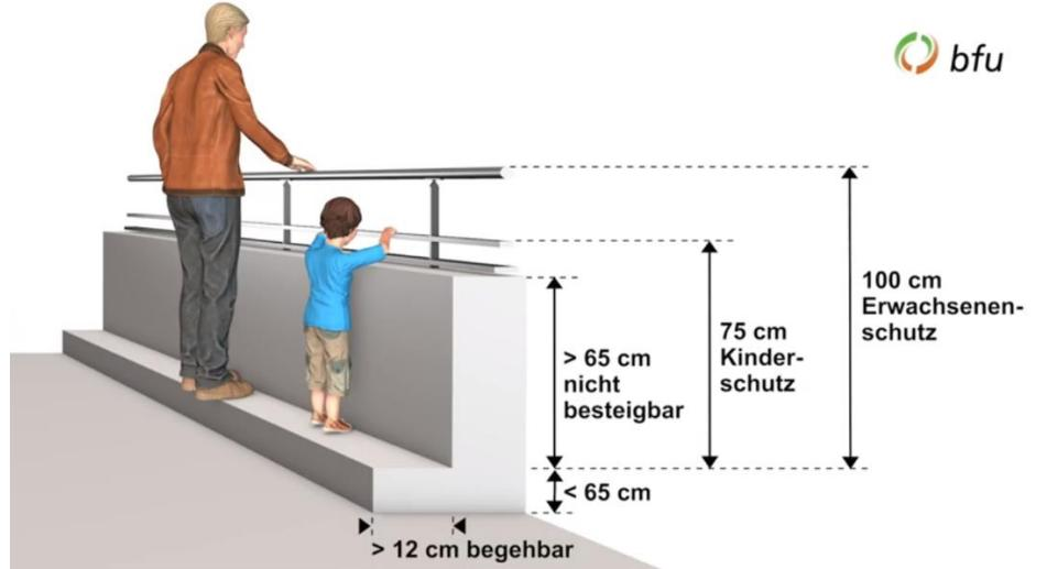
*Slika 4: Zaštitna ograda s betonskim zidom (situacija 3) [8]*
