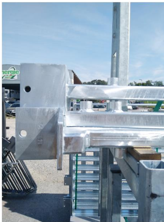
Slika 55: Zavareni stupovi nakon cinčanja [11]
