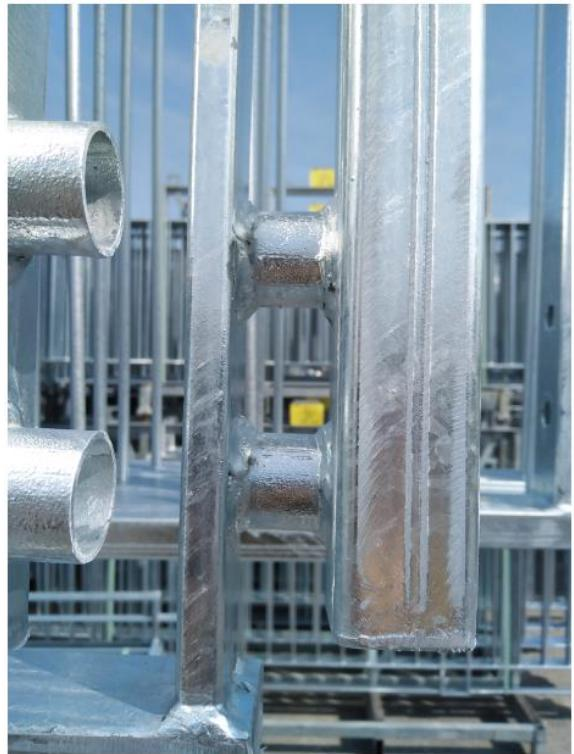
Slika 56: Zavareni "Segment" s stupom nakon cinčanja [11]
