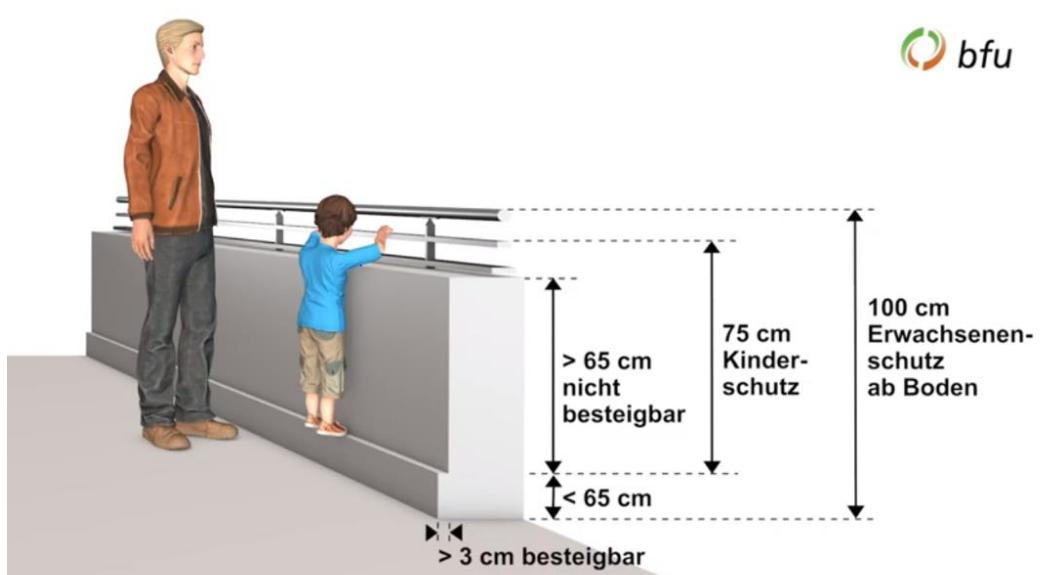
*Slika 3: Zaštitna ograda s betonskim zidom (situacija 2) [8]*
