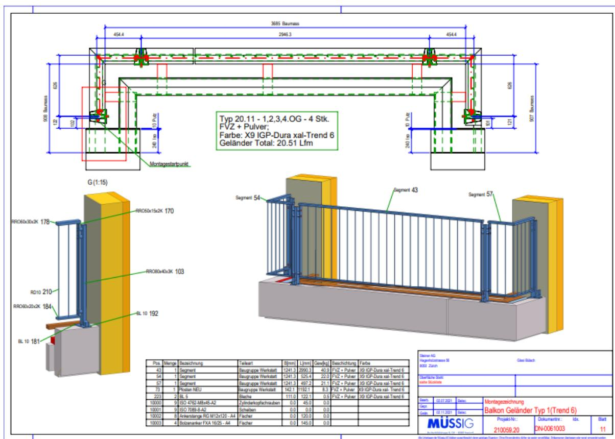
Slika 14: Plan montaže balkonske ograde 1 [11]
