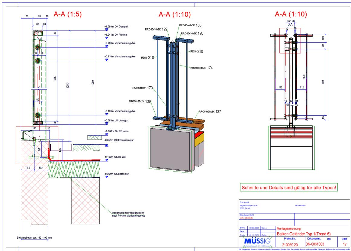
Slika 15: Plan montaže balkonske ograda 2 [11]
