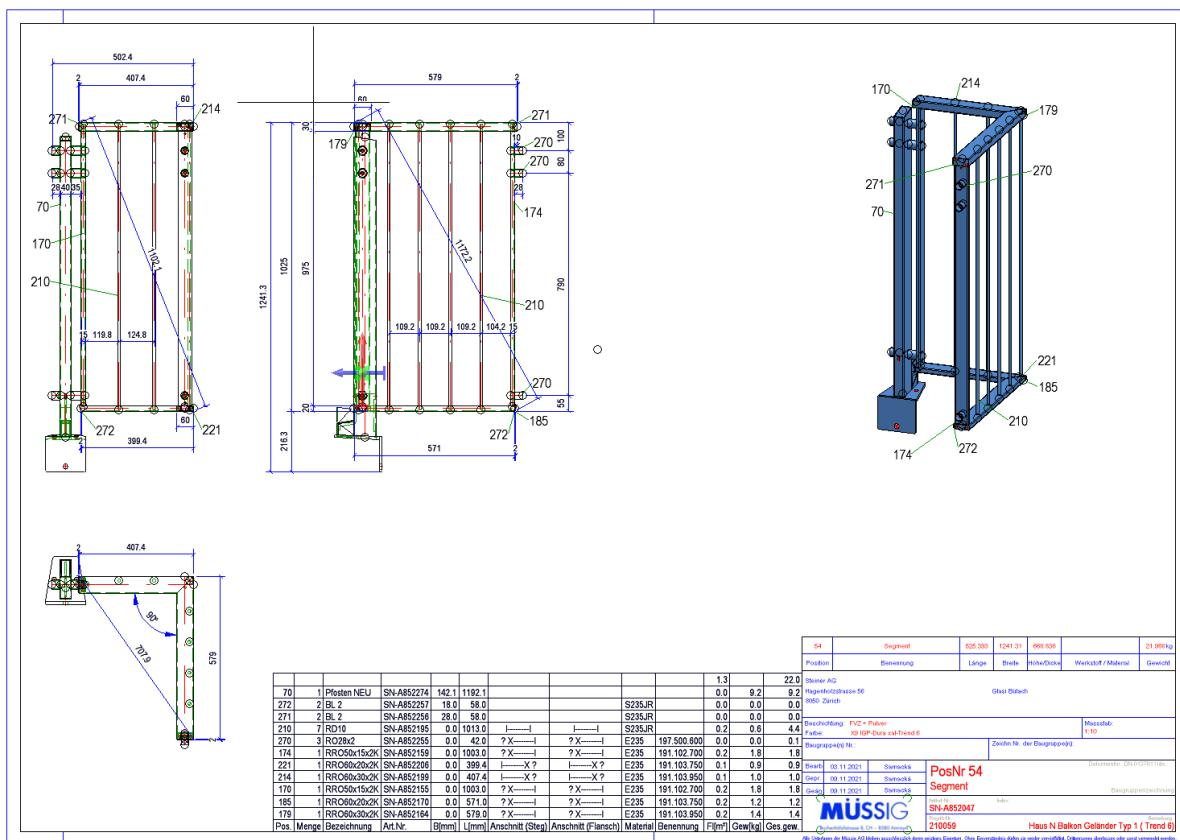
Slika 40: Radionički nacrt Pozicija 54 [11]
