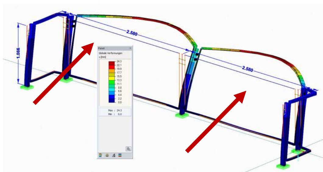
Slika 47: Globalna deformacija s razmakom stupova 2580 mm [11]
