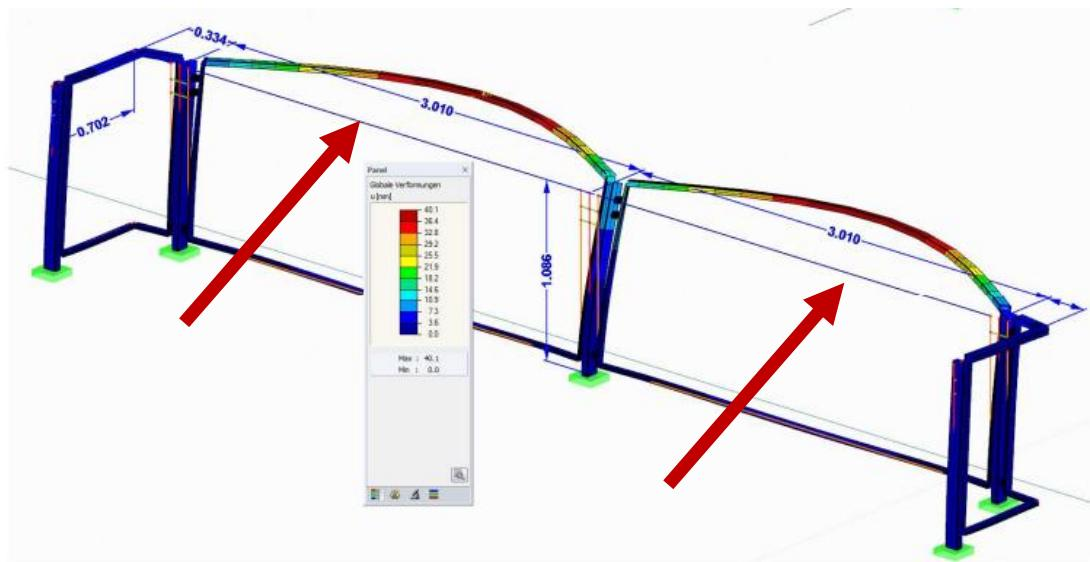
Slika 49: Globalna deformacija s razmakom stupova 3010 mm [11]
