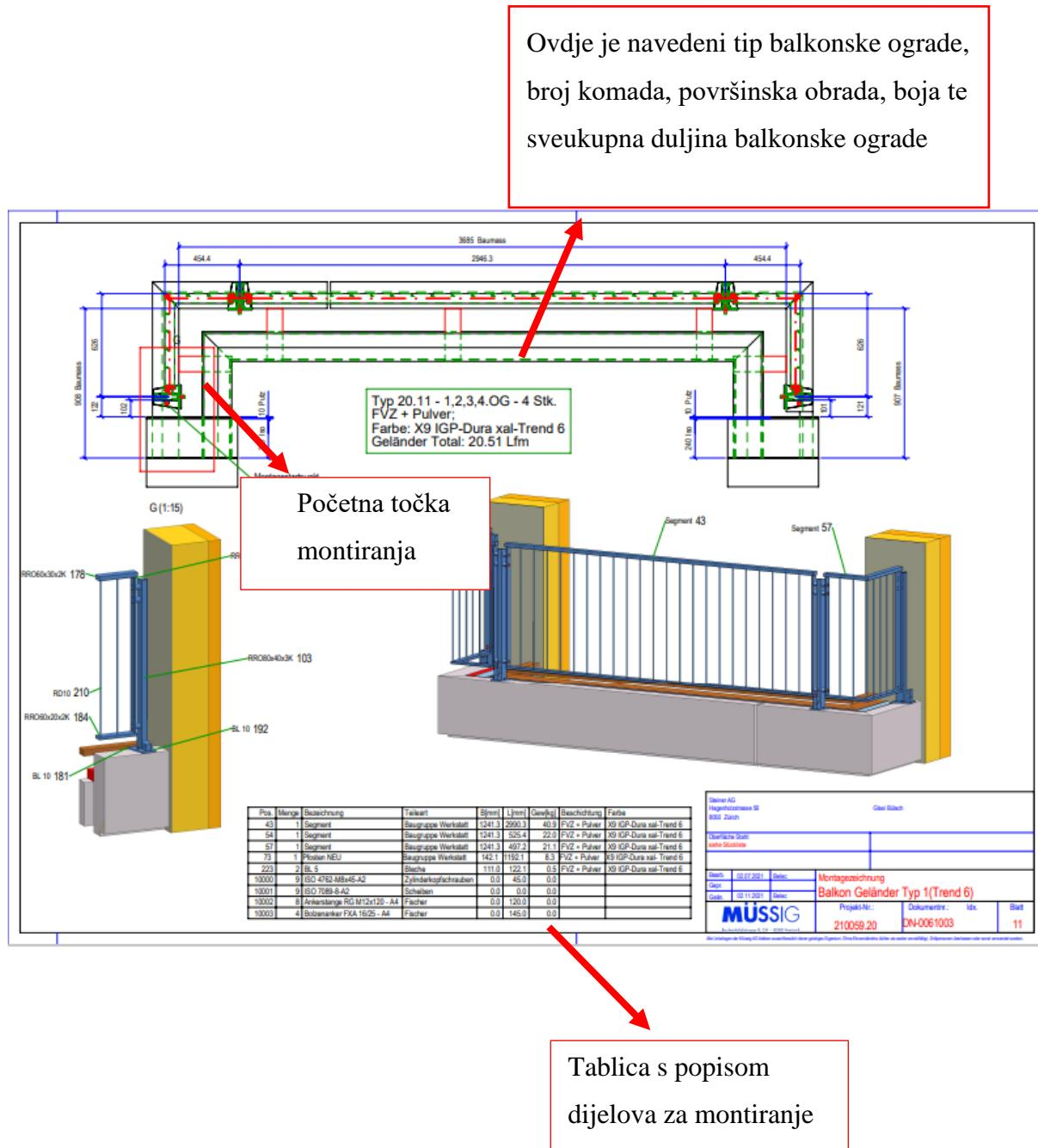
Slika 32: Plan montaže balkonske ograde [11]
