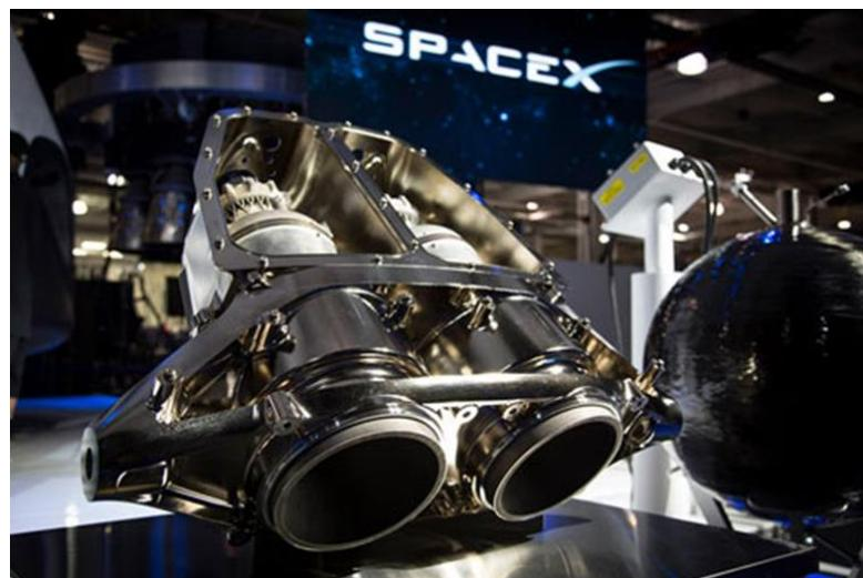
Slika 15. 3D tiskani "The SuperDraco" motor tvrtke SpaceX [22]
