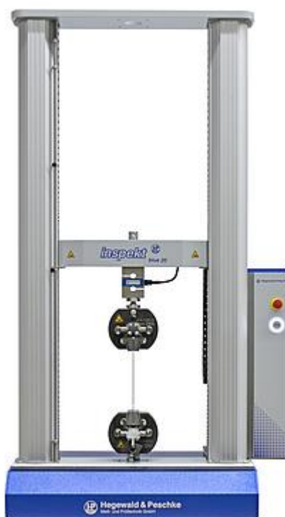
Slika 34. Kidalica proizvođača Hegewald & Peschke [31]
