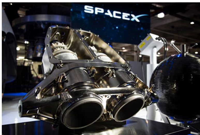
Slika 15. 3D tiskani "The SuperDraco" motor tvrtke SpaceX [22]
