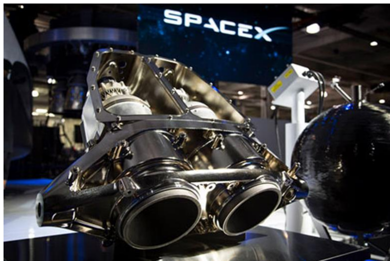
Slika 15. 3D tiskani "The SuperDraco" motor tvrtke SpaceX [22]
