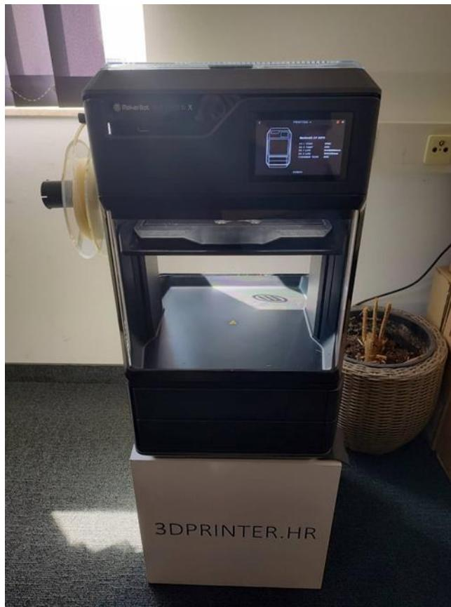
Slika 28. FDM uređaj korišteni za ispis PLA uzorka
