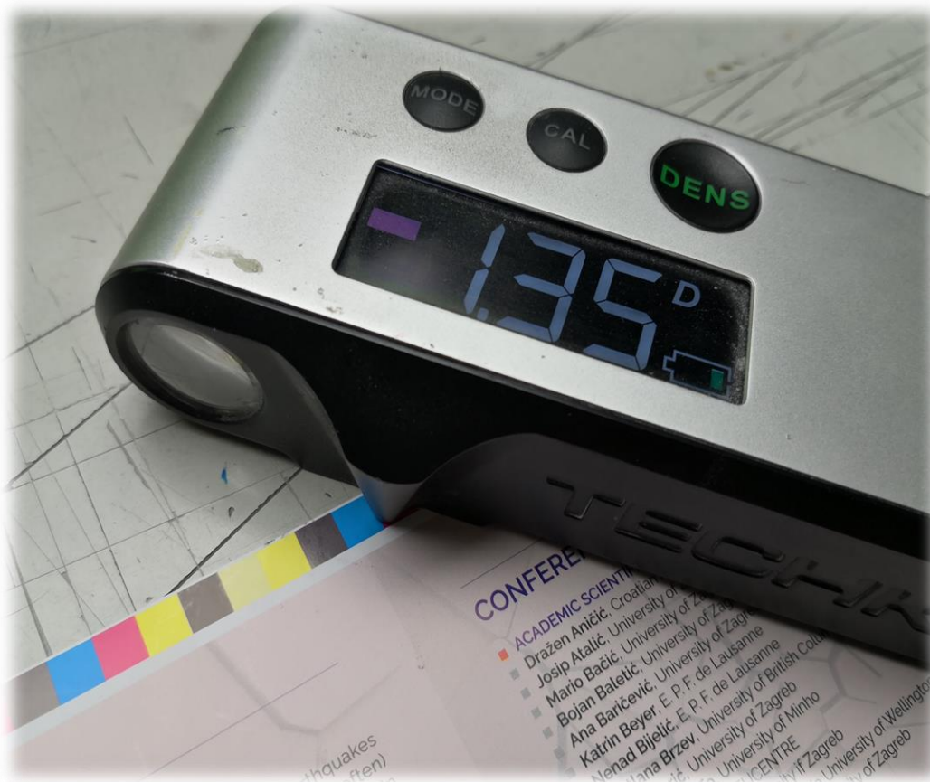
Slika 15. Mjerenje klina (kontrolnog stripa) denzitometrom
