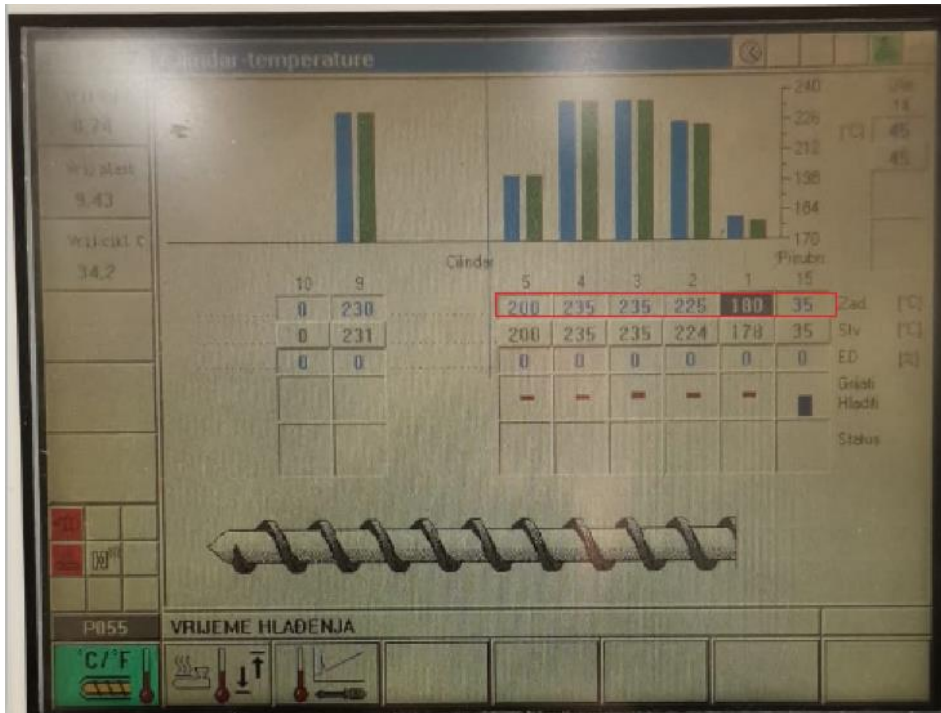
Slika 4.10.1. temperaturne zone cilindra ubrizgavalice [46]
