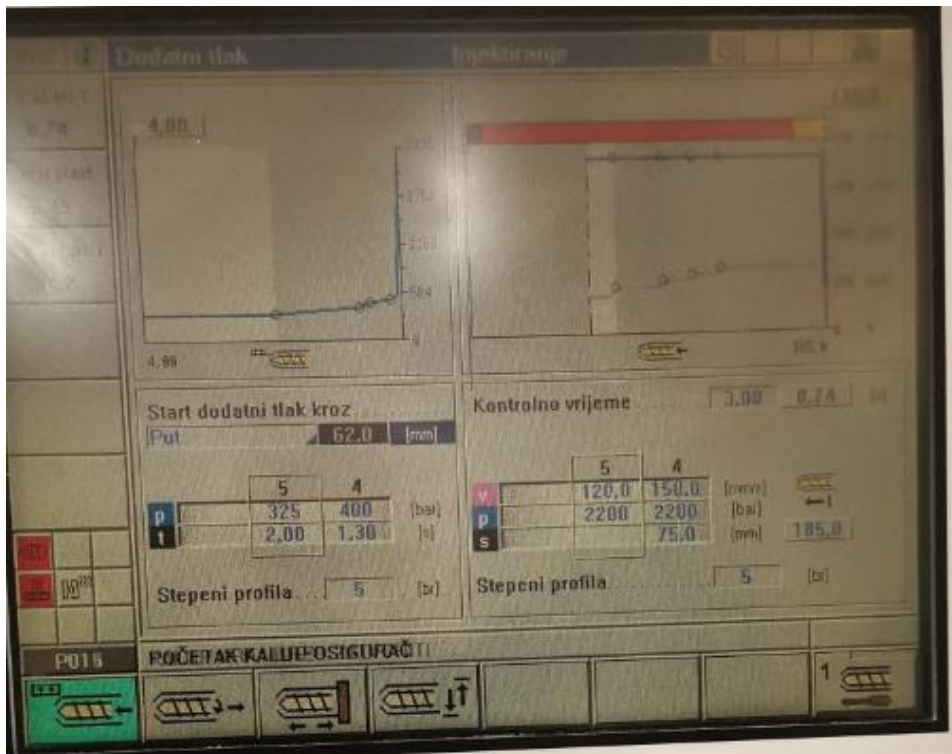
Slika 4.10.5. faza ubrizgavanja i djelovanja naknadnog tlaka [49]
