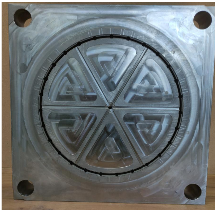
Slika 4.9.2.2.2. ploča kalupne šupljine na pomičnom dijelu kalupa [41]
