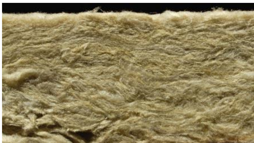
Slika 5. Struktura mineralne vune [8]
