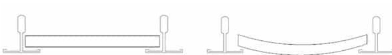
Slika 71. Progib zasićenog stropa vlagom [12]
