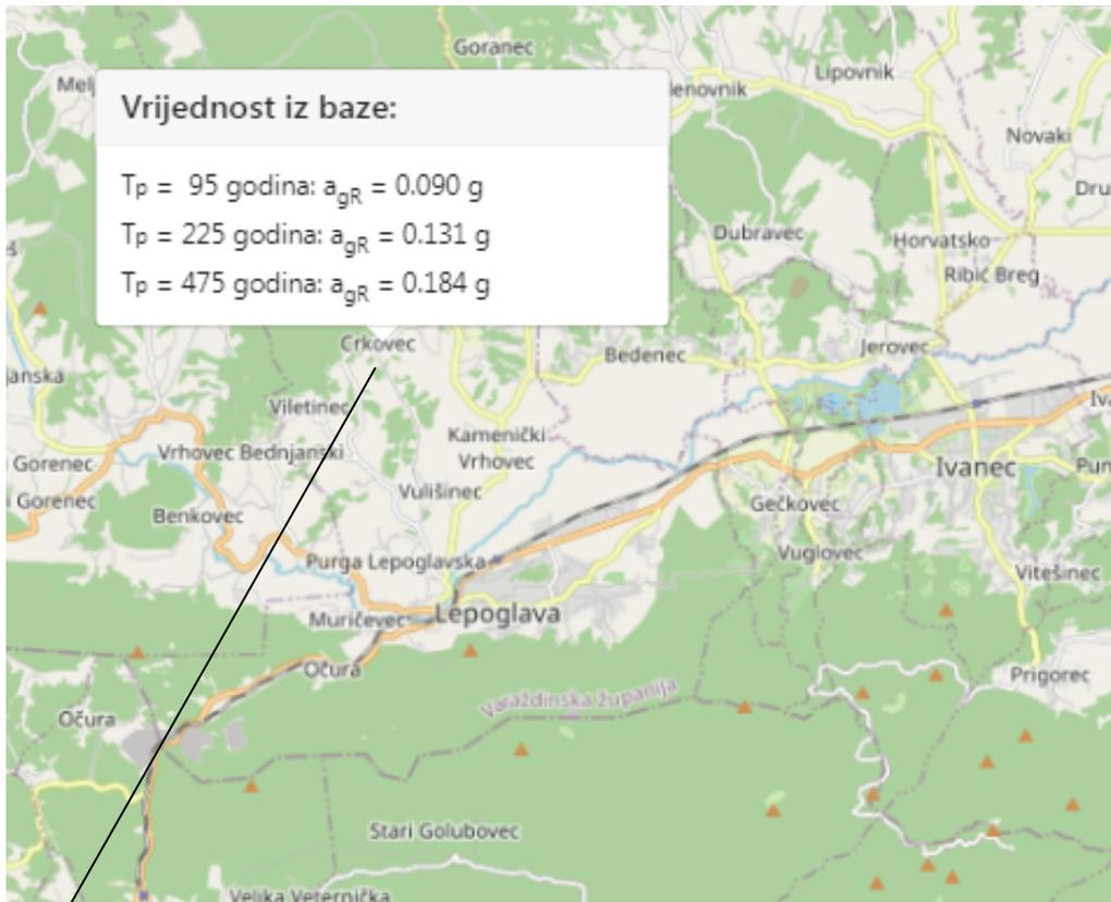
Slika 6.8. Parametar vršnog ubrzanja tla za promatranu lokaciju
