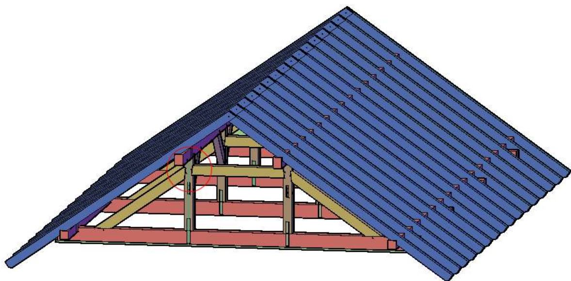
Slika 9.19 Spoj stupa i vezne grede – položaj veza
