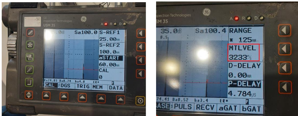
Slika 52. Pozicije signala na ultrazvučnom uređaju
