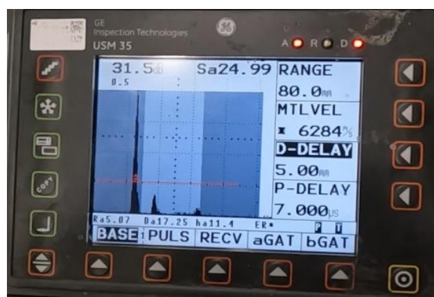
Slika 65. Baždarenje dvostruke sonde
