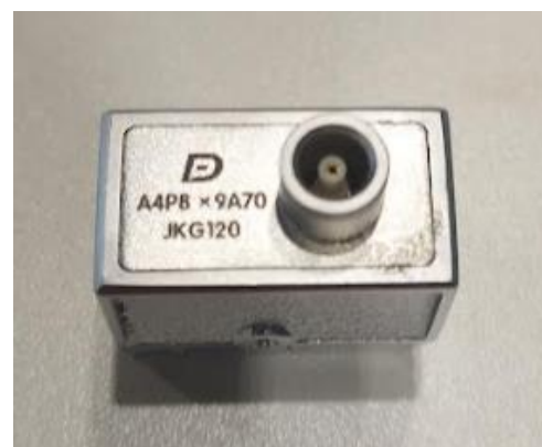
Slika 45. Kutna sonda JKG120
