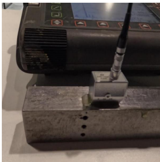
Slika 59. Provjera na referentom uzorku
