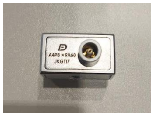
Slika 44. Kutna sonda JKG117
